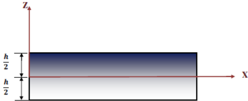
شکل ۱-۵ ورق FG با تغییر تدریجی مواد تشکیل دهنده فقط در راستای ضخامت
