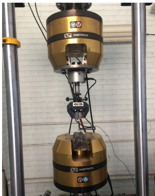
شکل ۲-۴ دستگاه آزمون کشش اینسترون ۸۸۰۲.
