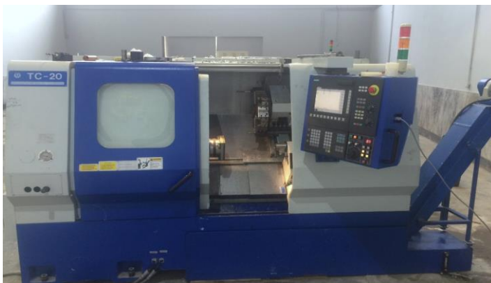
شکل ۴-۷ دستگاه تراش CNC سه محور مدل D-802.
