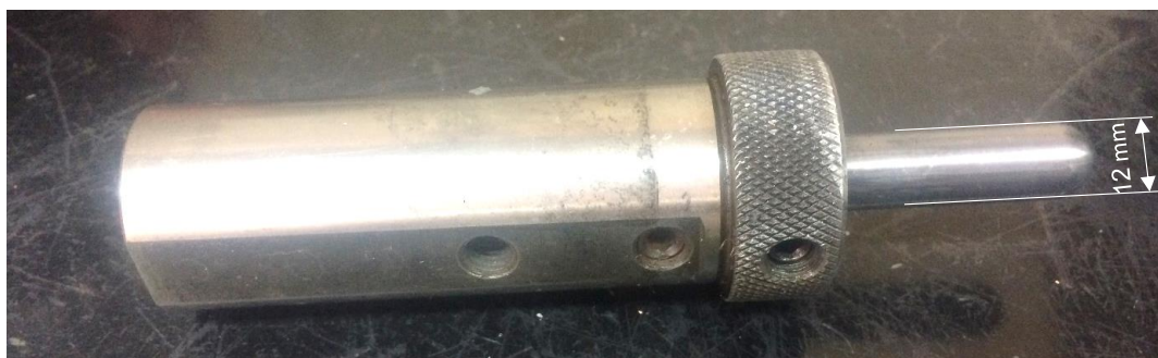
شکل ۴-۴ ابزار صلب سرکروی کارباید تنگستن با ابزارگیر مخصوص تراش CNC.
