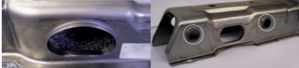
شکل ۲-۵: کاربردهای لبه‌کاری در ورق‌های فلزی در صنعت خودروسازی [۹].
