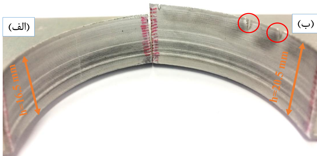
شکل ۳۷-۵ بررسی قطر سوراخ اولیه بر ارتفاع دیواره در شکل‌دهی تدریجی تک نقطه‌ای الف- قطر سوراخ اولیه ۳۰ mm ب- قطر سوراخ اولیه ۲۶ mm
