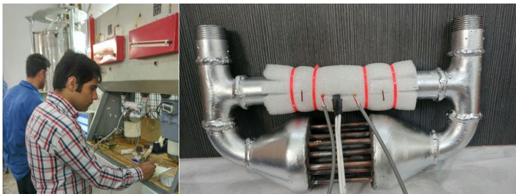
شکل ۴-۶: نمایی از دبی سنج با لوله حسگر مسی و محیط کالیبراسیون
