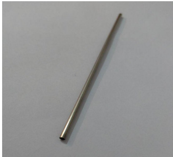
شکل ۳-۳: تصویر لوله‌ی حسگر ساخته‌شده از استیل
