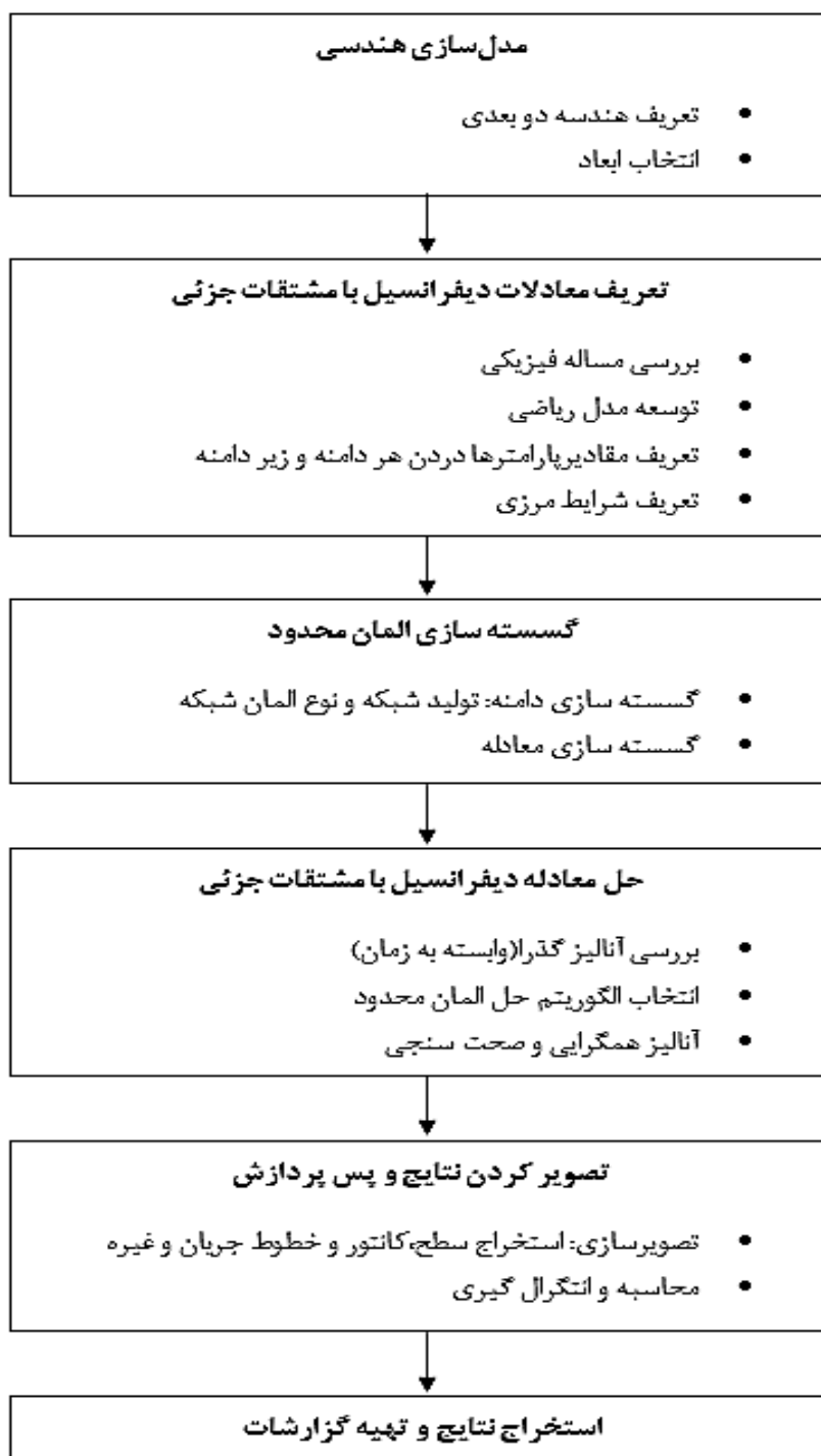
شکل ب-۱: مراحل مدل‌سازی فرآیند جدایش و تشکیل قطره در نرم‌افزار کامسول
