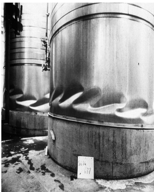
شکل (۱-۱) نمونه‌هایی از وقوع پدیده کمانش در پوسته‌های استوانه‌ای
