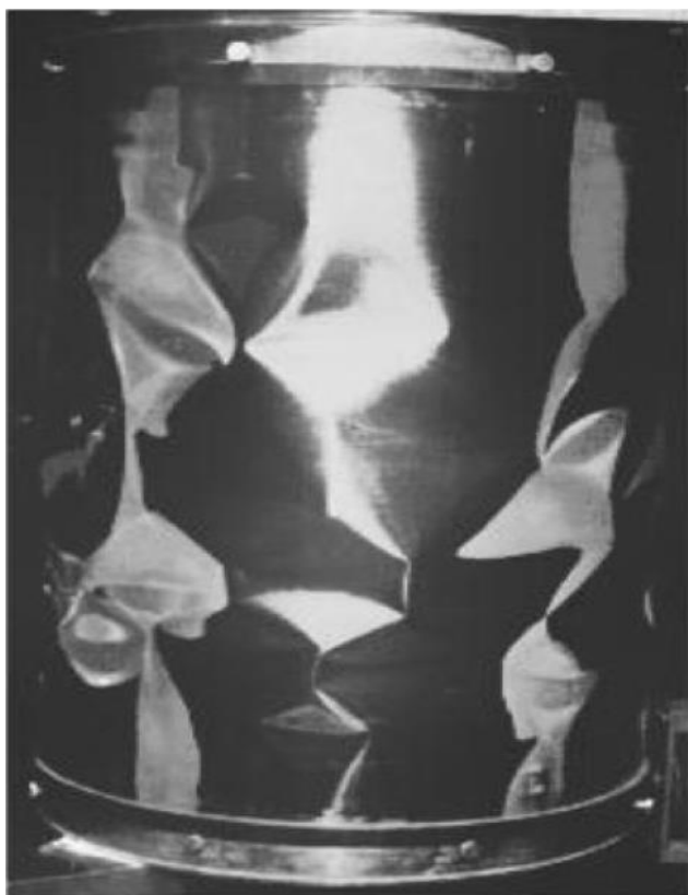
ب: شکل مد کمانش واقعی تحت فشار محوری
