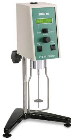
شکل ۲-۲ ویسکومتر Brookfield مدل DVE-LV
