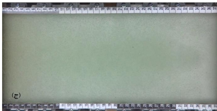
شکل ۳-۳ حالت‌های مختلف نورپردازی محیط متخلخل: الف) نورپردازی مستقیم از پشت محیط متخلخل ب) نورپردازی بک لایت ج) نورپردازی از بالا و پوشاندن پشت محیط متخلخل با یک صفحه سفید
