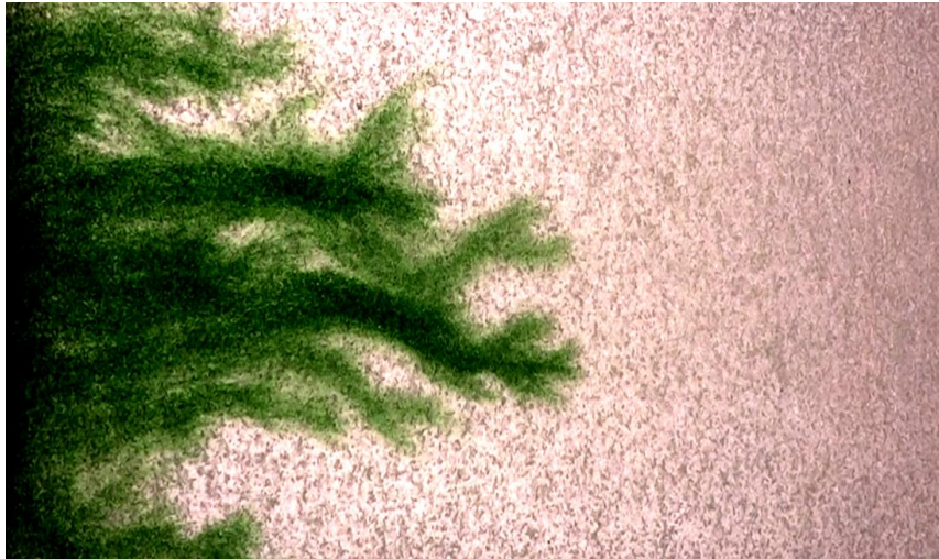
شکل ۱-۱ ناپایداری انگشتی لزج در حالت مخلوط شدنی
