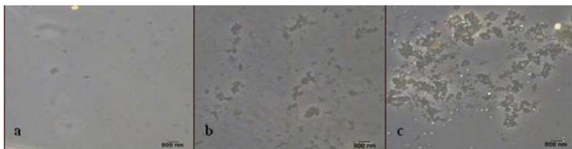
شکل ۳-۱- افزایش انباشتگی نانوذرات با افزایش زمان برای مخلوط آب اکسید مس ( \phi=0/1 ) (الف) ۲۰ دقیقه (ب) ۶۰ دقیقه (ج) ۷۰ دقیقه [۷]
