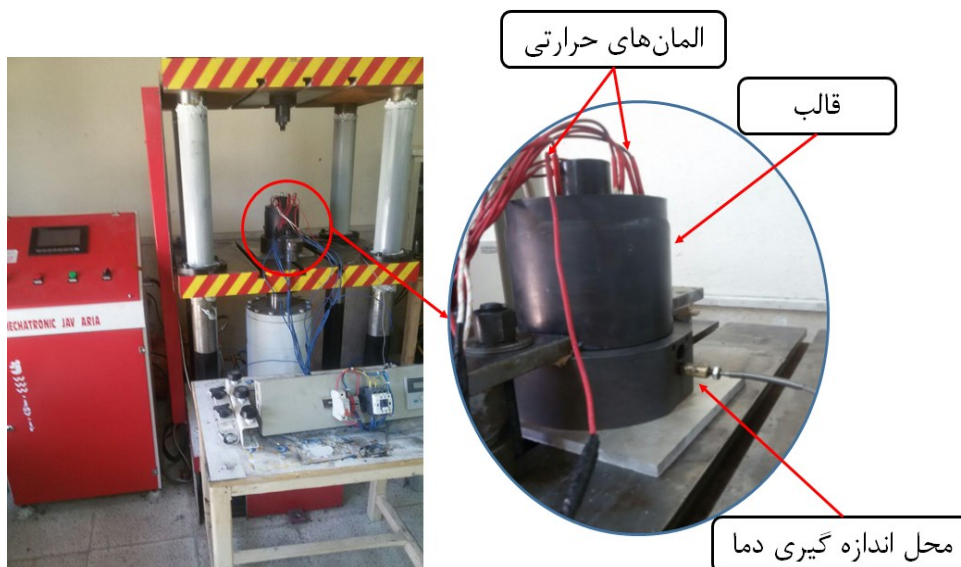
شکل ۲-۴ قالب، المان‌های حرارتی و مدار کنترل دمای فرایند.
