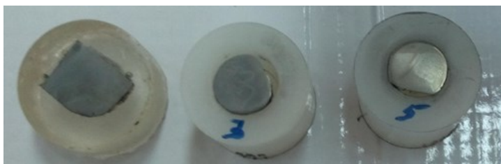
شکل ۲-۷ نمونه‌های مانت شده
