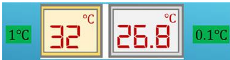
شکل ۲-۶ خطای اندازه‌گیری وسایل رقمی (دیجیتالی)
