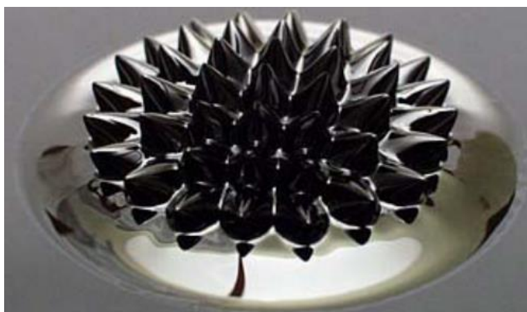
شکل ۶-۵ مایع مغناطیسی فروفلوید
