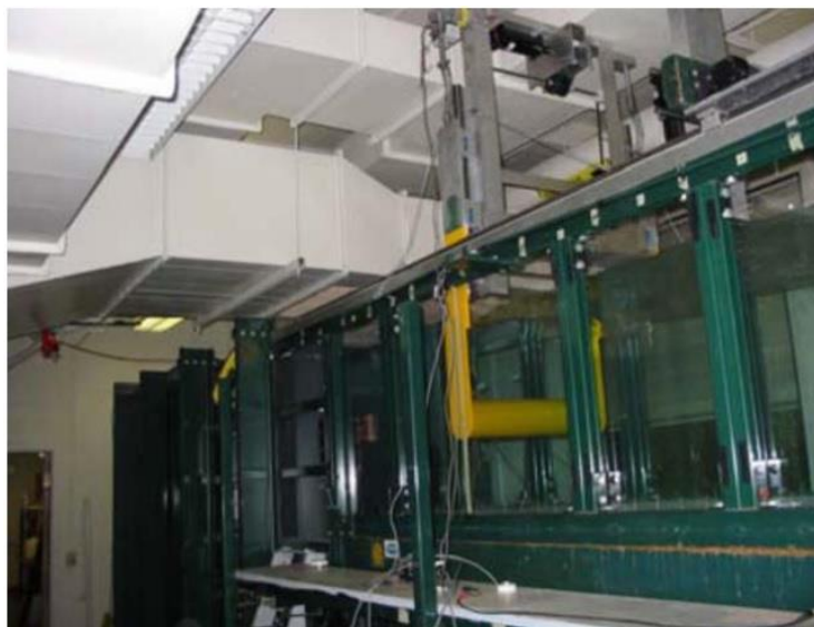
شکل ۲-۱۲ مبدل تولید توان از ارتعاشات ناشی از گردابه در دانشگاه میشیگان [26]
