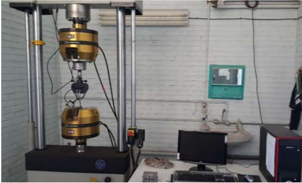
شکل ۲-۱۵- دستگاه اندازه گیری آزمون کشش مورد استفاده.
