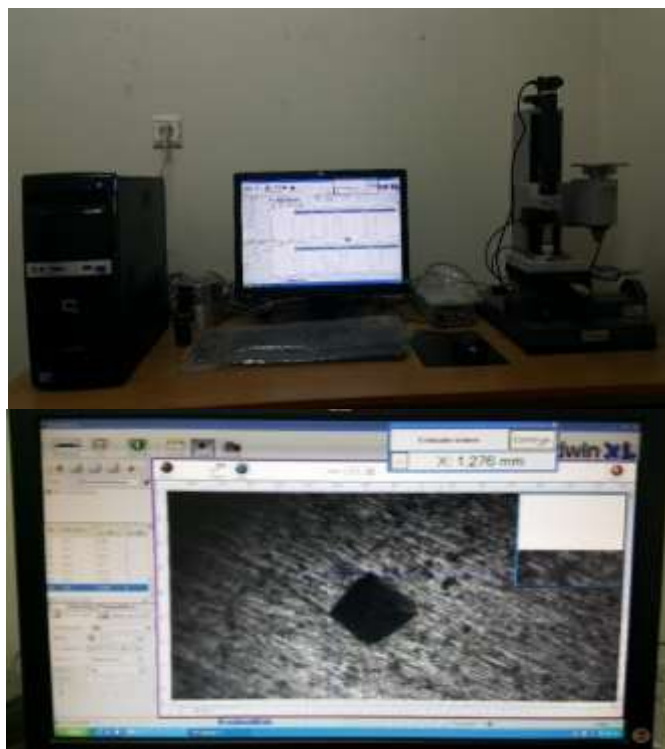
شکل ۲-۱۱-دستگاه اندازه گیری میکرو سختی ویکرز.
