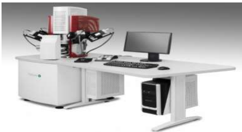
شکل ۲-۱۲- دستگاه میکروسکوپ الکترونی روبشی مورد استفاده .
