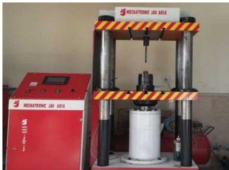
شکل ۲-۴- دستگاه پرس هیدرولیکی ۱۰۰ تن مورد استفاده.
