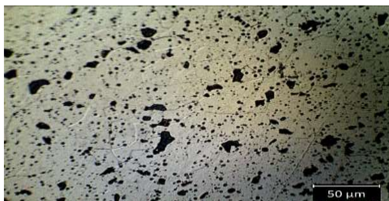
شکل ۳-۱۲- تصویر متالوگرافی از نمونه خام توسط میکروسکوپ نوری با بزرگنمایی x500.
