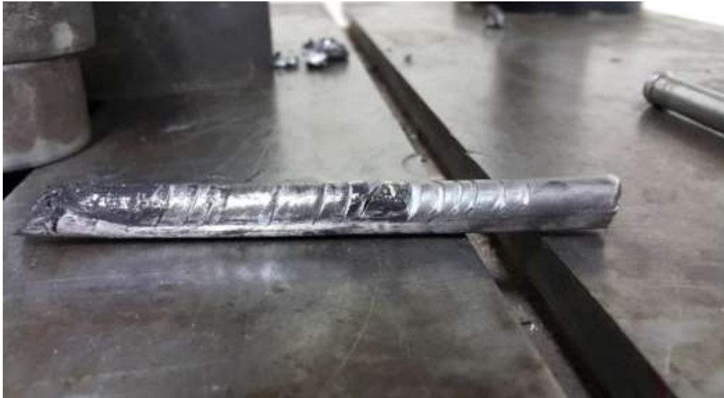
شکل ۲-۶- بریده بریده شدن قطعه طی فرآیند در دمای محیط .
