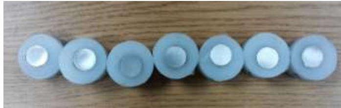
شکل ۲-۱۰- نمونه های پولیش خورده جهت آزمون های سختی سنجی و متالوگرافی.
