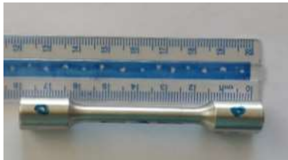
شکل ۲-۱۴-نمونه ای از قطعات آماده شده جهت آزمون کشش.
