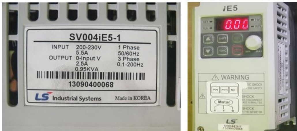
شکل (۳-۳) (الف) اینورتر (ب) مشخصات اینورتر مورد استفاده
