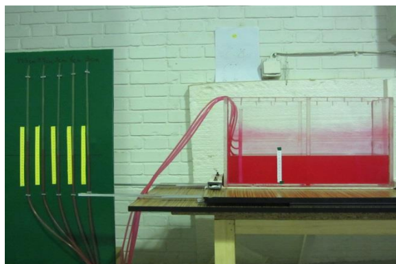
شکل (۳-۱۷) مخزن به همراه صفحه مانومتری و مانومترهای تعبیه شده
