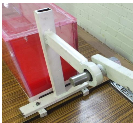
شکل (۹-۳) نحوه اتصال سازه فلزی صفحه متحرک به شاتون
