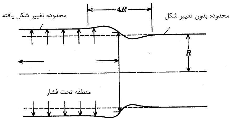
شکل (۱-۳) تغییر شکل پوسته تحت فشار متحرک [۲۴]
