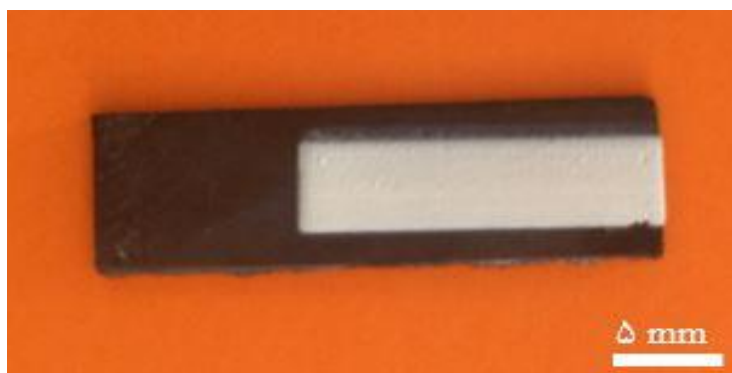
شکل ۳-۱. نمونه چاپ موفق از دوغاب آلومینا پس از ۳۰۰ بار چاپ
