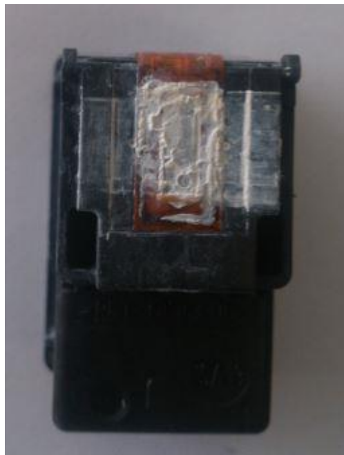
شکل ۳-۹. انباشته شدن دوغاب بر روی صفحه افشانک به علت کم بودن گرانیروی و یا تنظیم نبودن کشش سطحی
