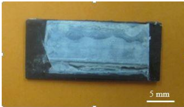
شکل ۳-۱۰. وجود ریزقطره‌ها بر روی سطح نمونه به علت کشش سطحی کم
