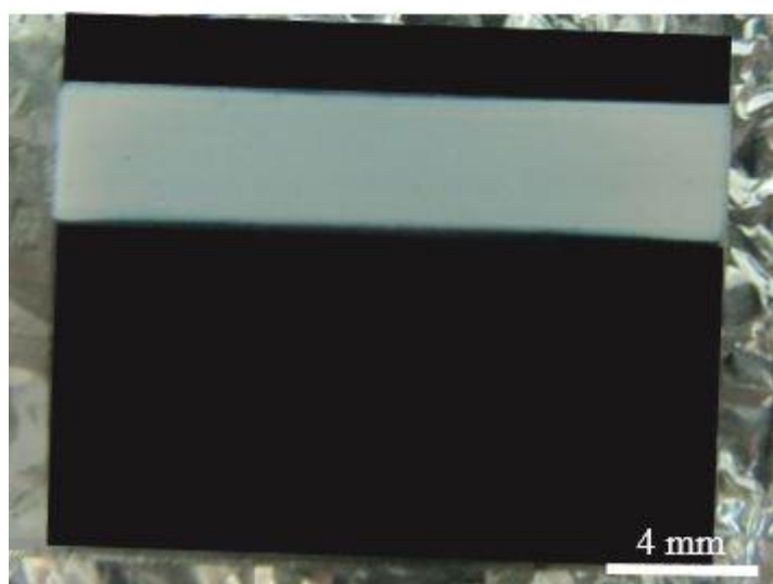
شکل ۳-۱. نمونه چاپ موفق از دوغاب آلومینا پس از ۳۰۰ بار چاپ
