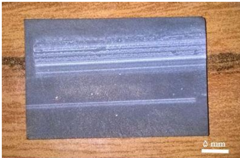
شکل ۳-۳. نمونه یک چاپ ناموفق حاصل ۵ بار چاپ
