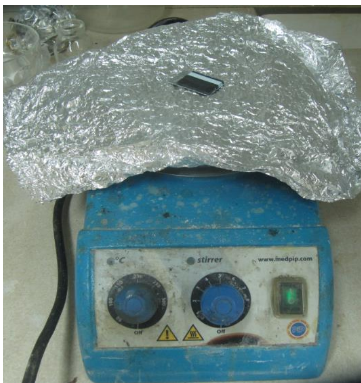
شکل ۲-۷. نمونه قرار گرفته بر روی صفحه داغ برای خشک شدن و خارج شدن حلال
