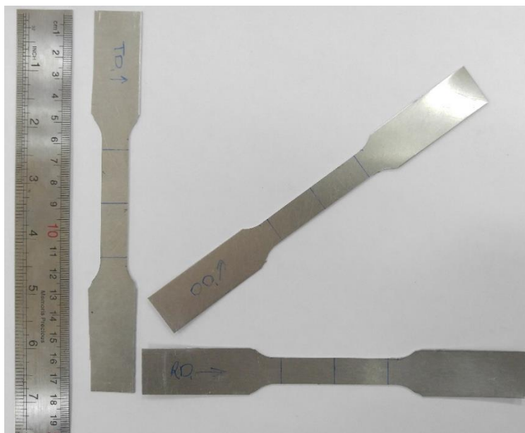
شکل ۱-۳: نمونه‌های ورق آلومینیومی برای آزمون کشش
