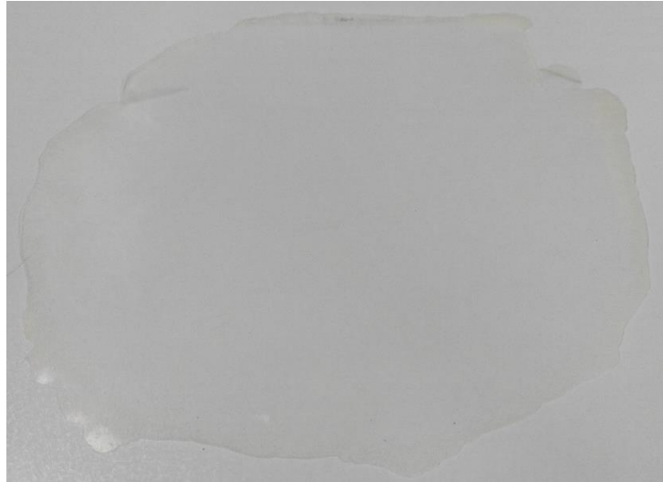
شکل ۳-۷: لایه پلی یورتان ساخته شده با ضخامت ۰/۶ mm
