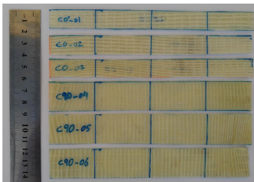
شکل ۲-۳: نمونه‌های هسته شامل پلی‌یورتان تقویت‌شده با فیبر شیشه گرید E برای آزمون کشش
