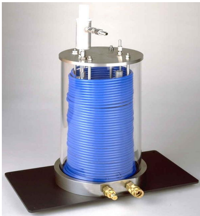
شکل ۱-۱: طرح شماتیک یک راکتور پلاگ
