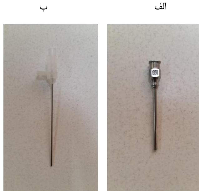
شکل ۲-۱۷. الف) سوزن ۱۴ با قطر داخلی ۱/۸ میلی‌متر ب) سوزن ۱۶ با قطر داخلی ۱/۰۷ میلی‌متر
