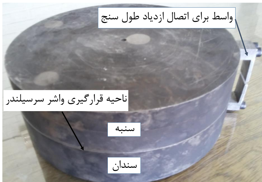
شکل ۲-۱۹: کفشک‌های ساخته‌شده جهت بارگذاری-باربرداری کلی
