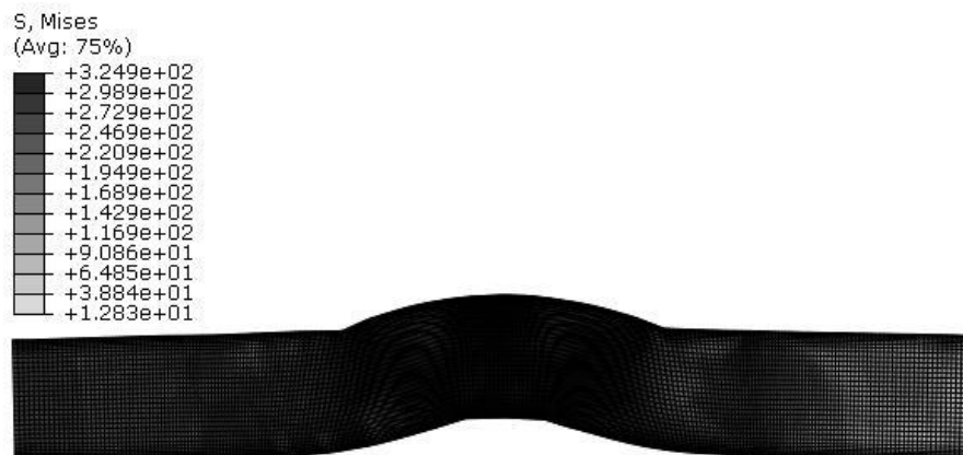
شکل ۳-۸: مدل شکل‌دهی متقارن محوری بید واشر سرسیلندر
