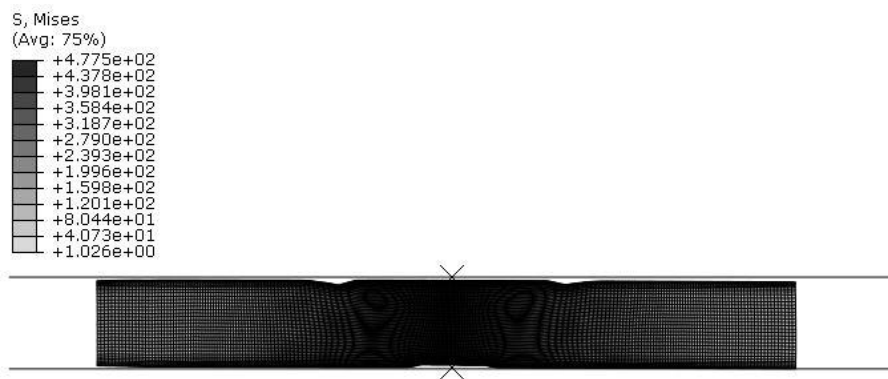
شکل ۳-۱۱: مدل المان محدود بارگذاری با پانچ و سندان تغییر شکل پذیر
