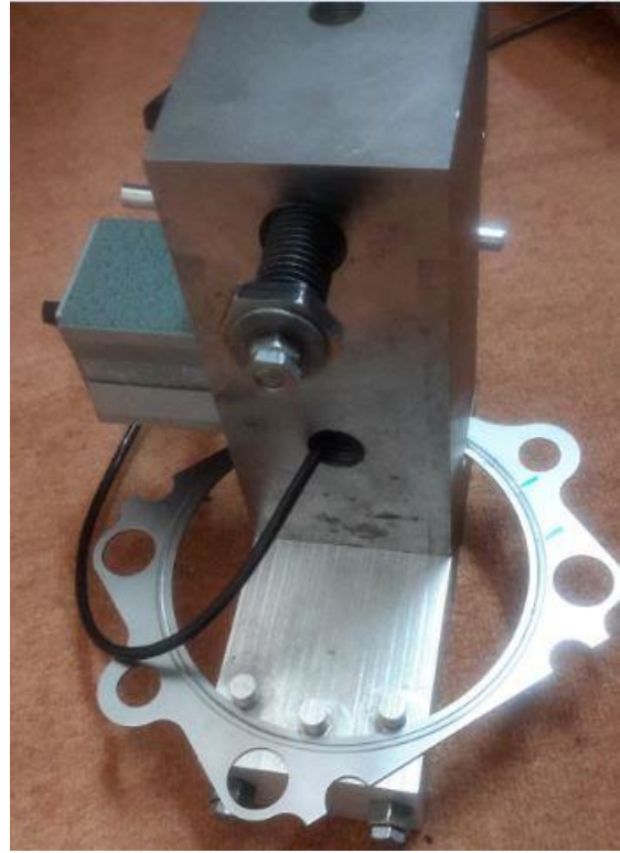
شکل ۲-۷: پیچ محرک بالای دستگاه
