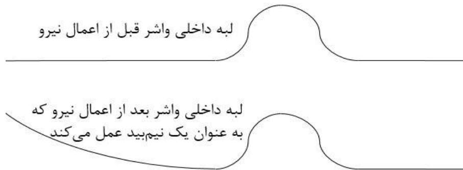
شکل ۴-۱۸: تغییرات لبه داخلی واشر سرسیلندر قبل و بعد از اعمال نیرو
