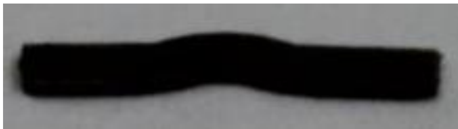
شکل ۳-۵: مقطع بریده‌شده از نمونه الف با دستگاه برش وایرکات
