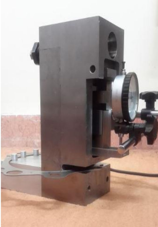
شکل ۲-۶: قرارگیری واشر زیر پراب
