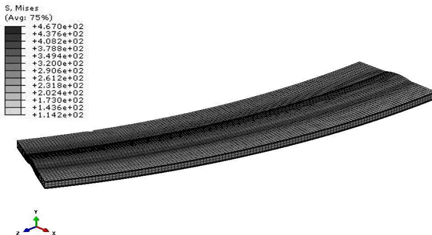
شکل ۳-۱۵: شکل دهی ۳۰° بید واشر سرسیلندر
