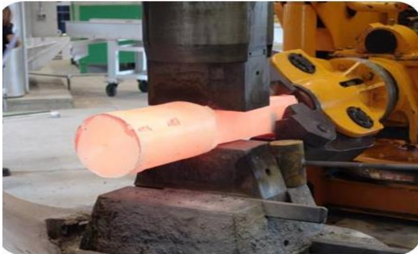
شکل ۱-۱۰: آهنگری شمش زیرکونیوم
