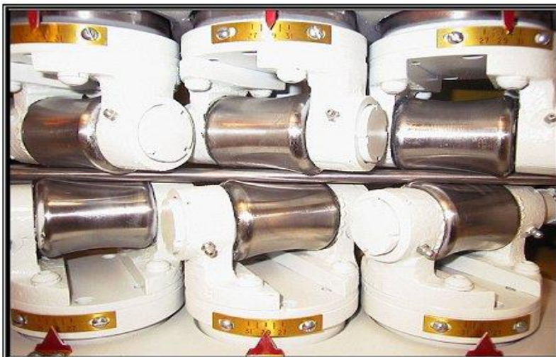
شکل ۱-۲۵: تنظیم غلتک‌ها با استفاده از میله تست
