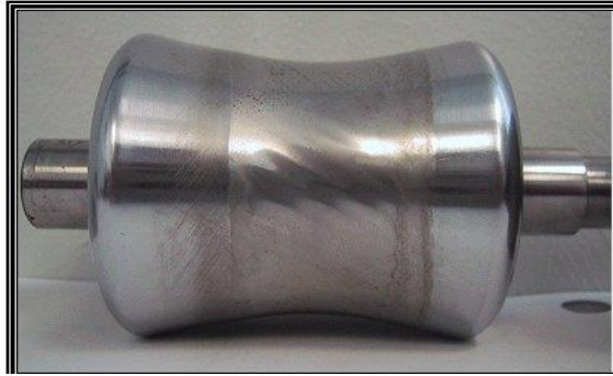
شکل ۱-۳۴: تنظیم غلط غلتک و خوردگی سطح آن
