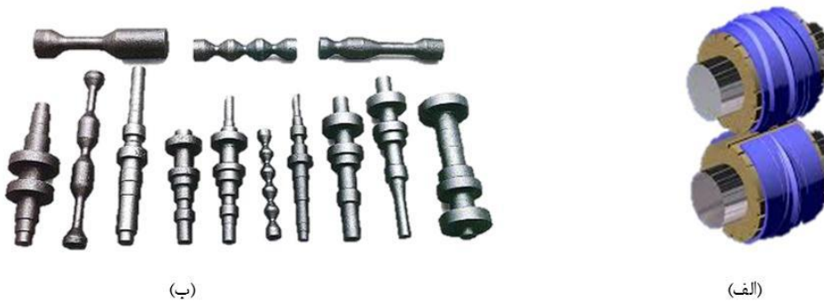
شکل ۱-۵: (الف) غلتک‌های نورد عرضی (ب) قطعات تولیدی
