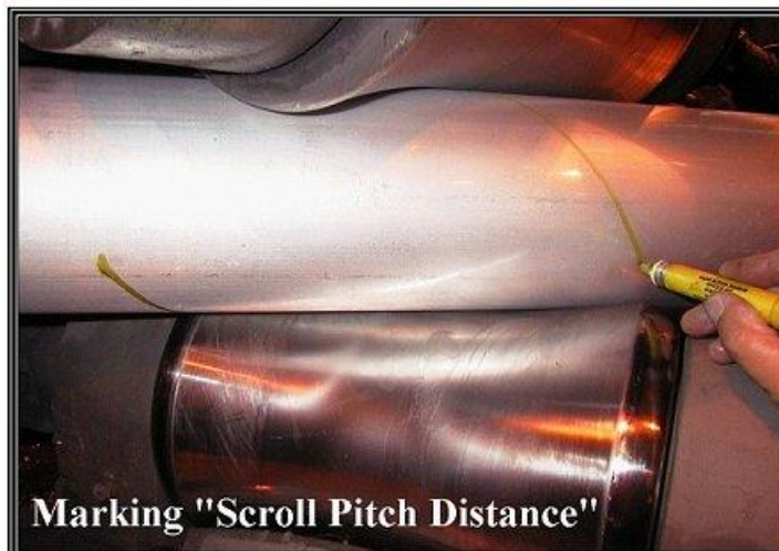
شکل ۱-۲۹: به دست آوردن جابجایی گام غلتک [۸]
