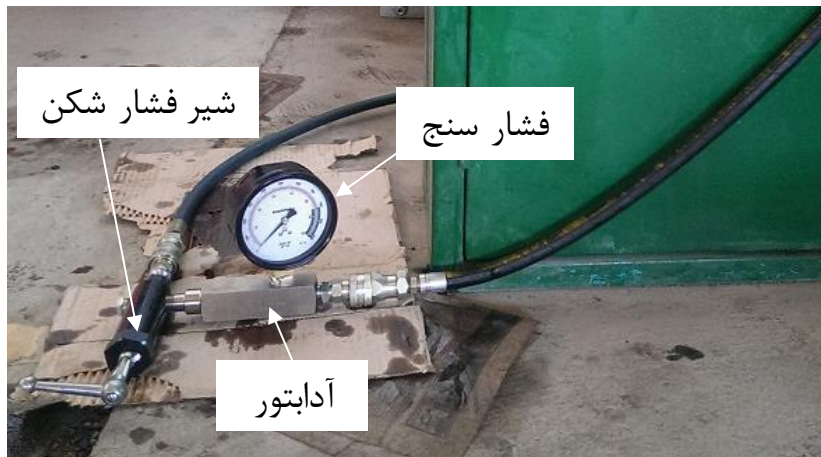
شکل ۲-۱۵: اجزای مدار کنترل برگشت فشار روغن
