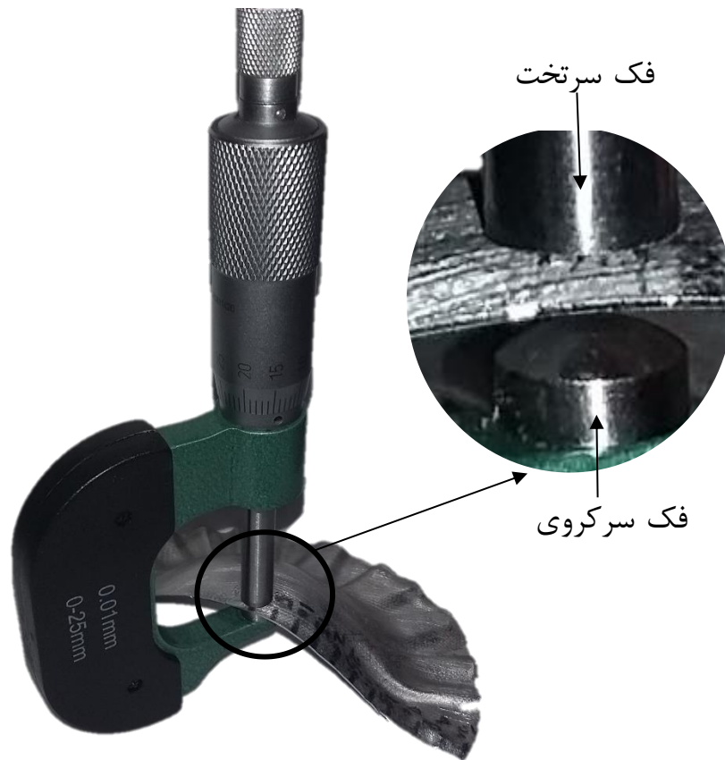
شکل ۴-۲۴: میکرومتر ضخامت سنج جهت اندازه‌گیری ضخامت ورق برش شده
