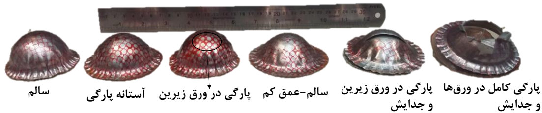
شکل ۴-۲۰: نمونه‌های سالم و معیوب در نسبت کشش ۱/۸
