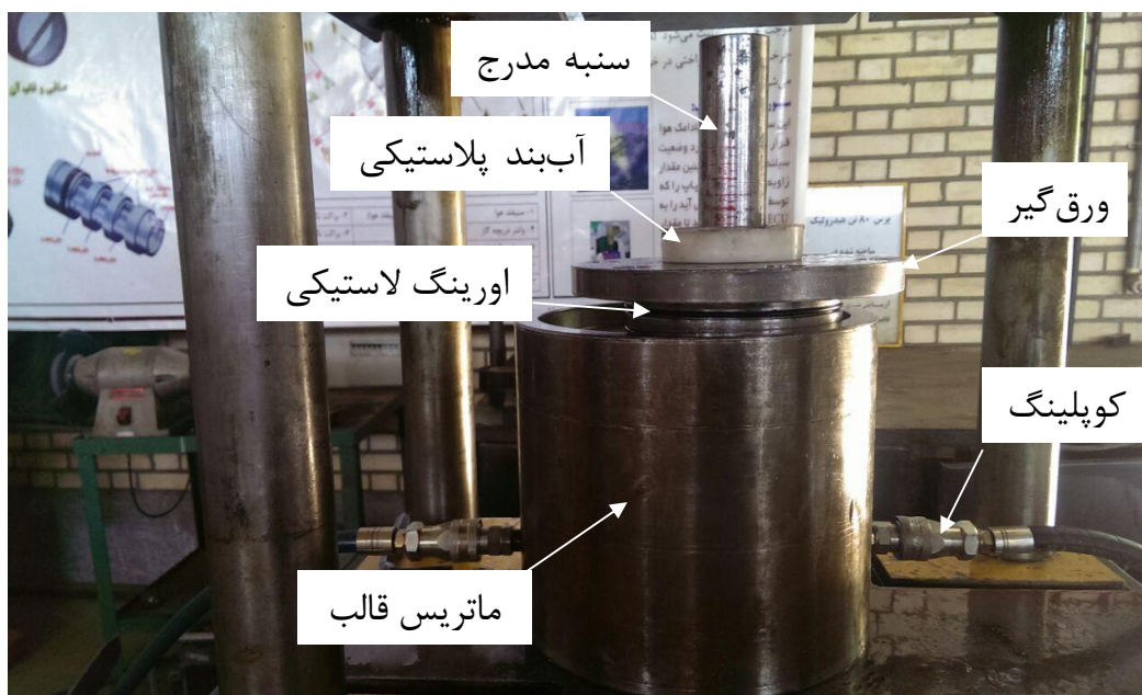
شکل ۲-۱۲: مجموعه سنبه و قالب کشش عمیق هیدرومکانیکی
