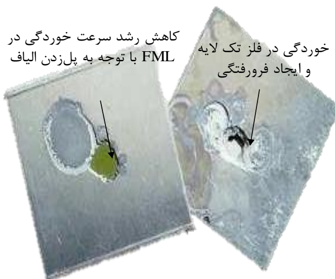
شکل ۱-۸: مقایسه‌ی آسیب خوردگی در FML و ورق تک لایه‌ی [۲]
