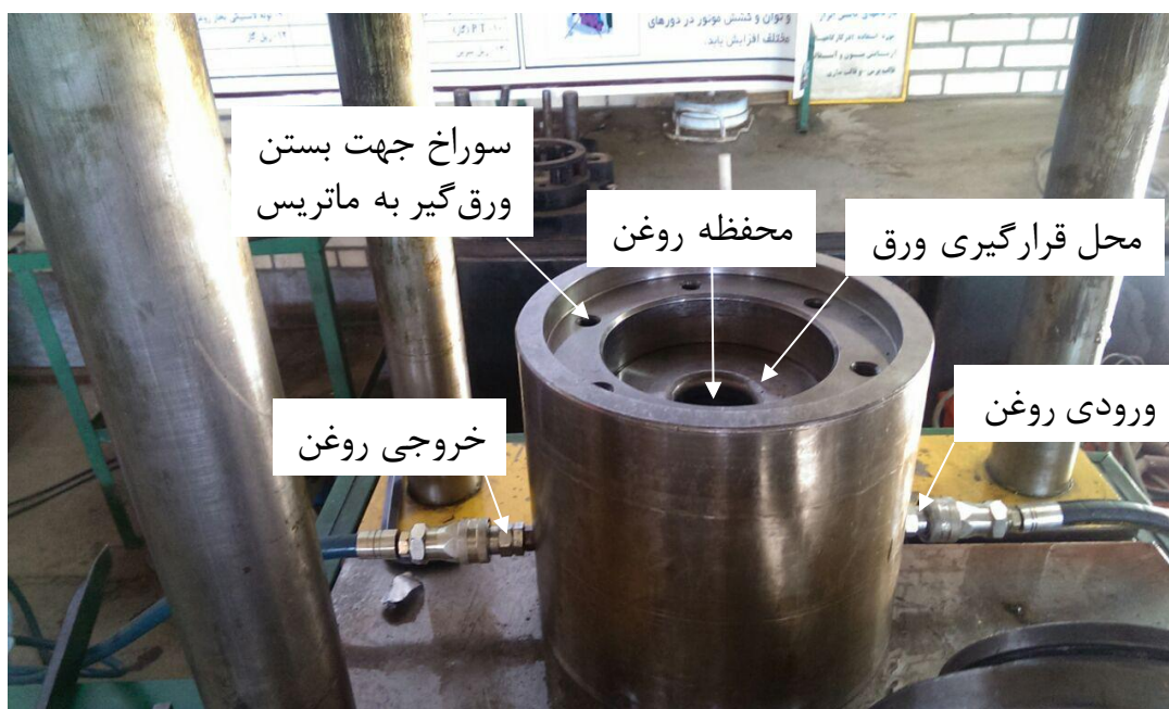
شکل ۲-۱۱: قالب کشش عمیق هیدرومکانیکی
