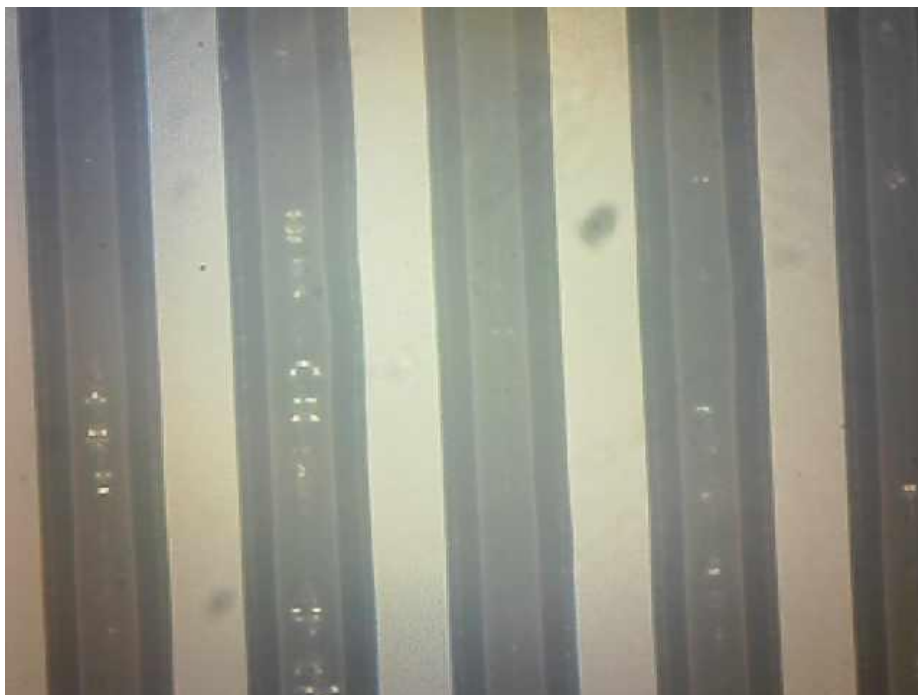
شکل ۴-۵ تصویر میکروسکوپ نوری از میکروکانال‌ها (نواحی تاریک عمق میکروکانال را نشان می‌دهد)
