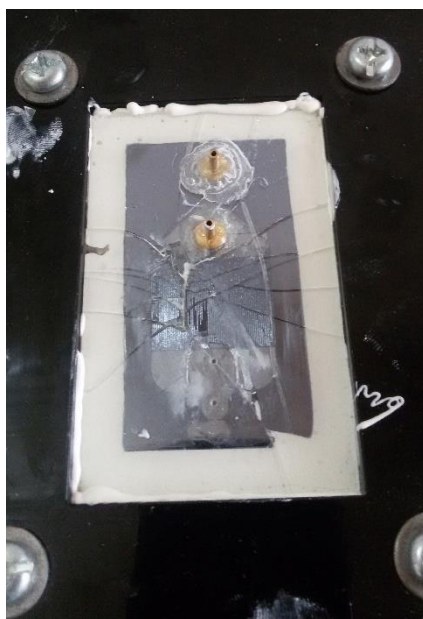
شکل ۴-۱۲ میکروکانال شکسته شده در اثر حرارت بالا
