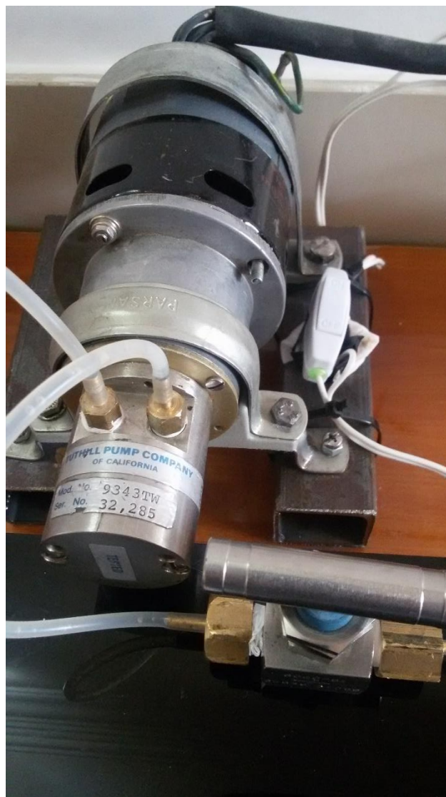
شکل ۴-۱۰ میکرو پمپ و شیر سوزنی استفاده شده در آزمایش
