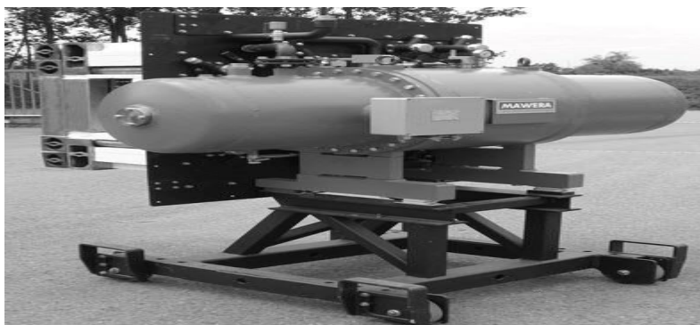
شکل (۱-۱۰): موتور استرلینگ ۳۵ کیلوواتی [۹]
