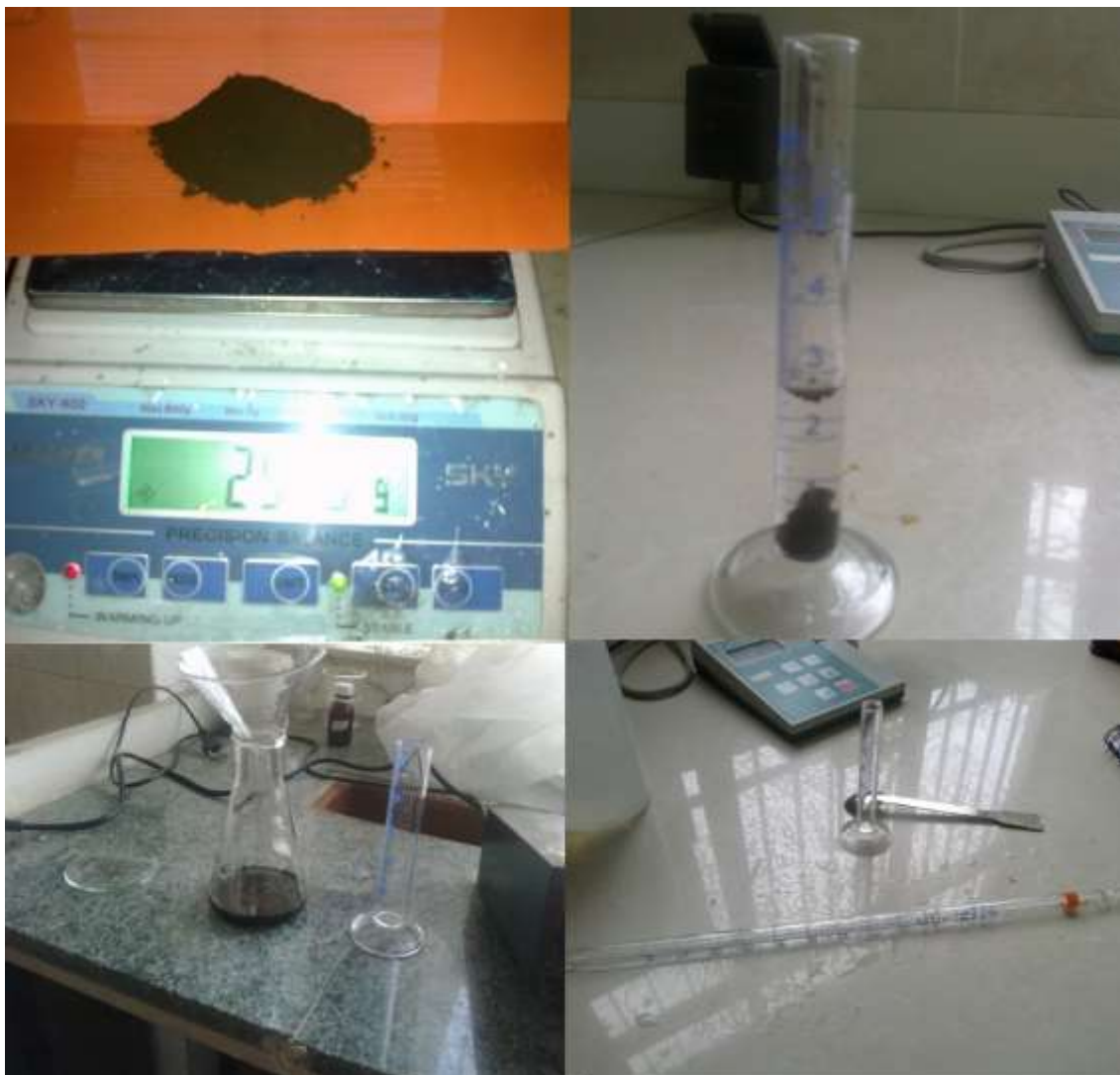
شکل پ- وسایل آزمایشگاه برای محاسبه چگالی ناخالصی‌های جریان گاز طبیعی
