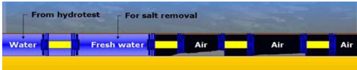
شکل ۲-۳ عملیات خروج آب و تزریق هوای خشک پس از تست هیدرواستاتیک [۱۹]
