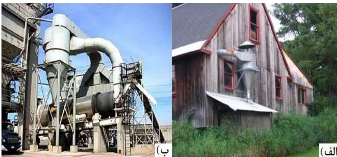
شکل ۴-۲ بکارگیری سیکلون‌ها در صنایع الف) کارگاه چوب‌بری ب) کارخانه آسفالت [۳۴]
