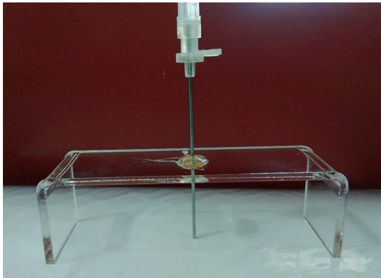
شکل ۱۱-۲ سوزن ۱۶G مورد استفاده برای تشکیل قطره.
