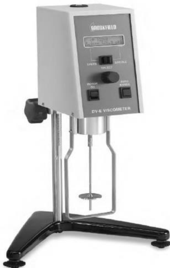
شکل ۲-۸ ویسکومتر مدل DVE-LV شرکت Brookfield
