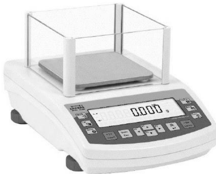
شکل ۲-۶ ترازوی مدل PS 510/C/1 محصول شرکت RADWAG.
