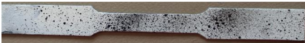
شکل ۱-۸- نمونه شبکه‌بندی به روش تصادفی
