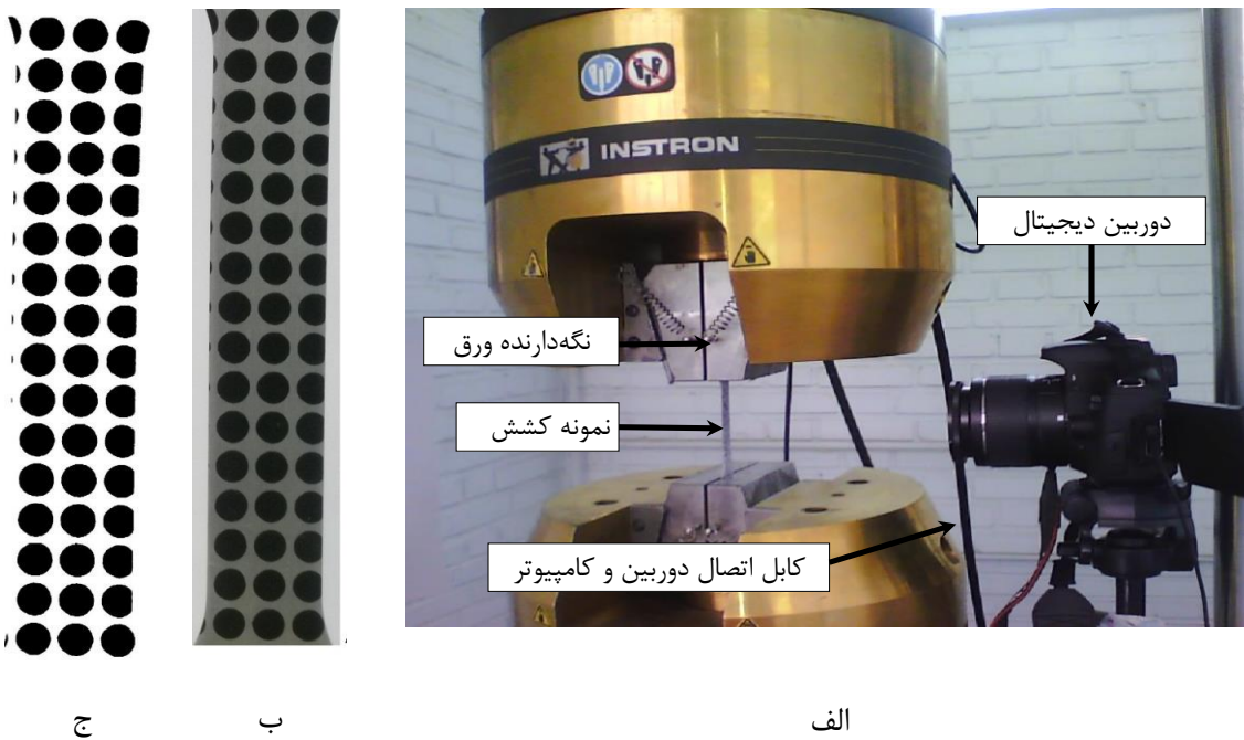
شکل ۲-۶- اندازه‌گیری مقادیر ناهمسانگردی در کشش نمونه با شبکه‌بندی منظم الف) اجزای آزمون، ب) خواندن تصاویر اولیه، ج) آستانه‌گذاری
