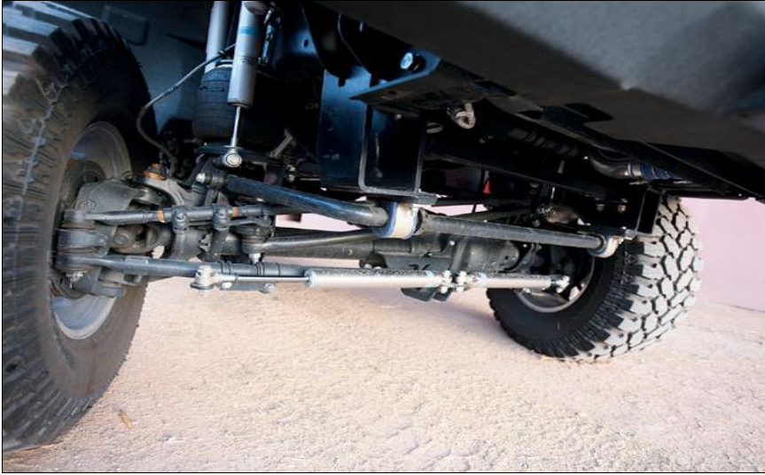
شکل ۱-۵- کاربرد دمپر سیال مگنتورئولوژیکیال در خودروهای نظامی هامر [۲۱].
