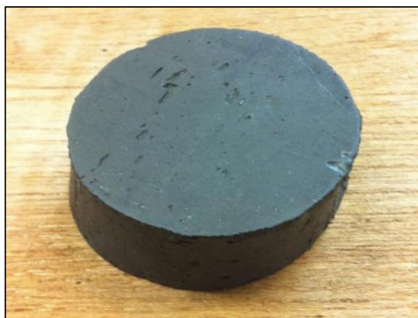
شکل ۹-۱- یک نمونه ساخته شده از الاستومر مگنتورئولوژیکال ایزوتروپ [۱۲].
