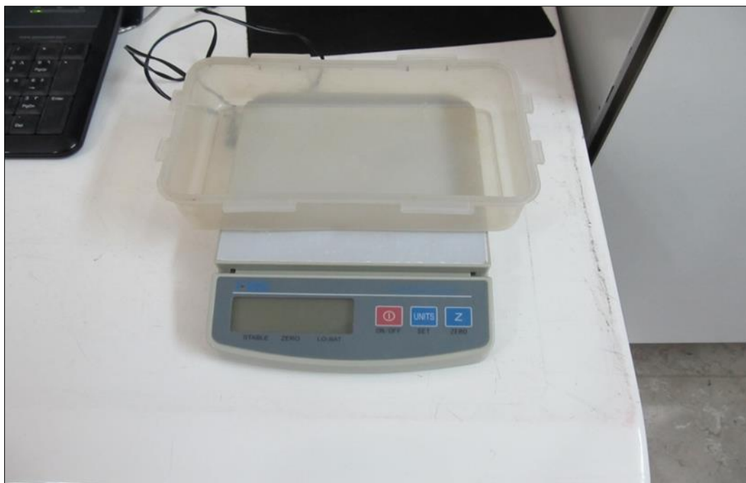
شکل ۱-۲- ظرف مخلوط برای اجزای لازم به همراه یک ترازو دیجیتالی با دقت ۰,۱ گرم.
