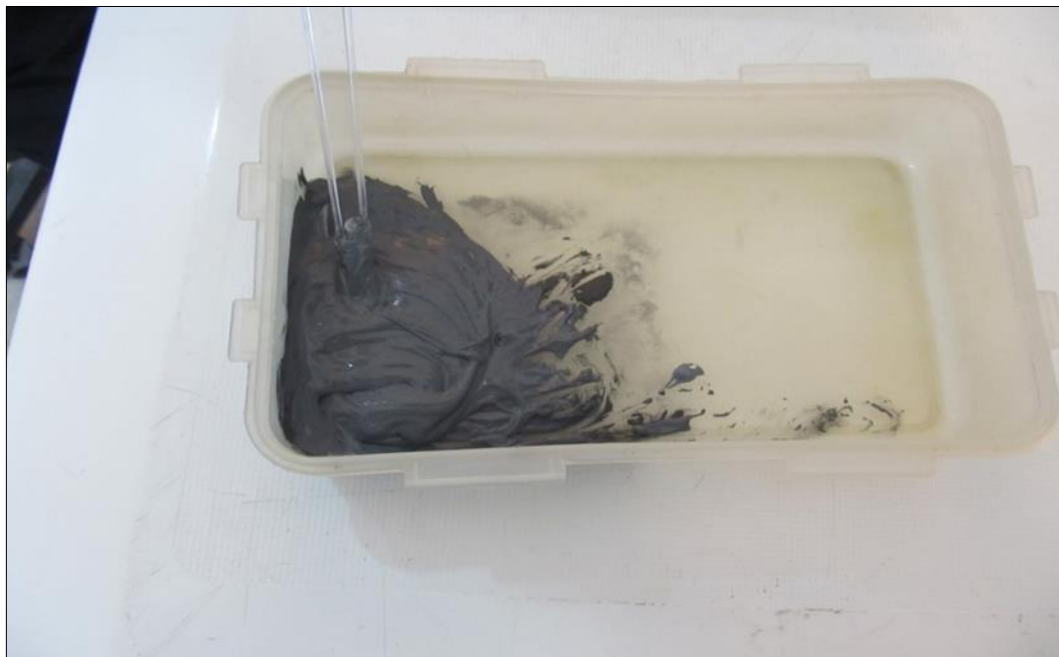
شکل ۲-۸- مخلوط هم زده شده شامل تمام اجزای تشکیل دهنده الاستومر مگنتورئولوژیکال.
