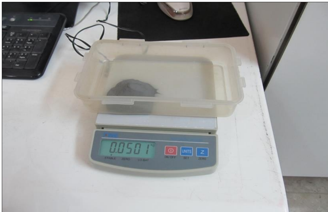
شکل ۲-۴- ذرات آهنی به میزان ۵۰ گرم.
