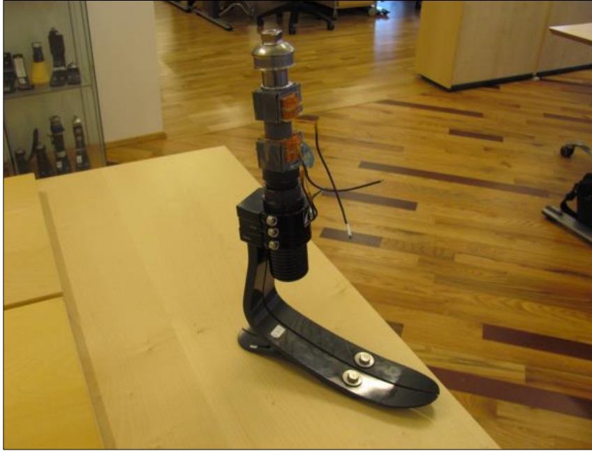
شکل ۱-۱۶- نمونه اولیه ساخته پای مصنوعی شامل الاستومر مگنتورئولوژیکال [۳۸].
