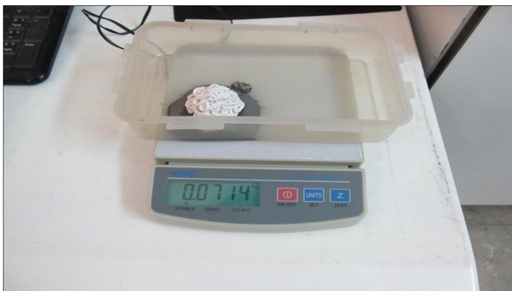
شکل ۲-۷- مجموع وزنی ۷۱,۴ گرم شامل اجزای تشکیل دهنده نمونه الاستومر مگنتورئولوژیکال.
