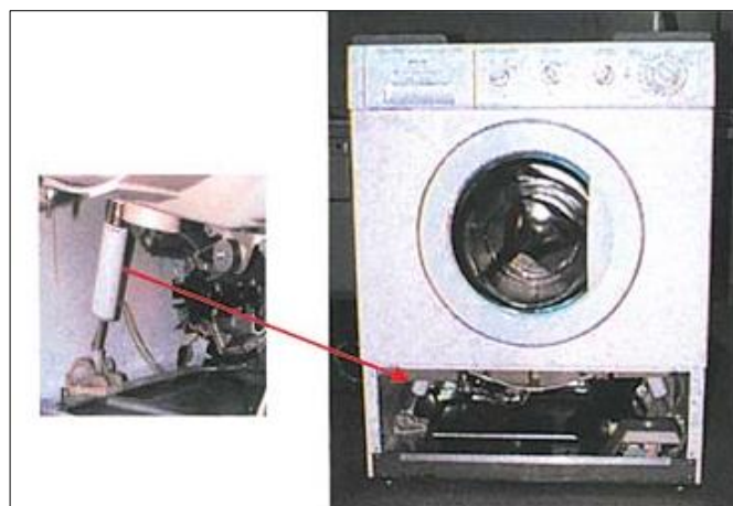
شکل ۴-۱- سیستم میرایی تنظیم شونده شامل دمپر سیال مگنتورئولوژیکال در ماشین لباسشویی [۲۰].
