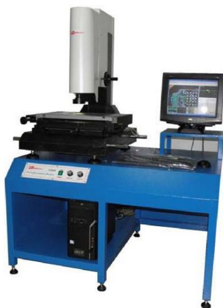
شکل ۱-۲۰، دستگاه VMM برای اندازه‌گیری سایش ابزار [۶]
