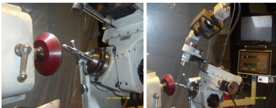
شکل ۲-۲۸، سنگ‌زنی زاویه آزاد لبه برشی مته
