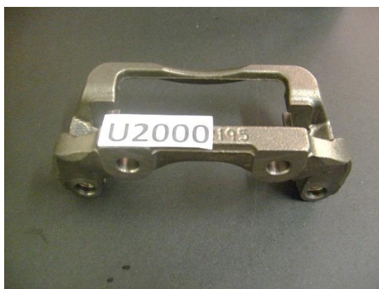
شکل ۲-۳۷، سوراخ ایجاد شده با مته بدون پوشش U بعد از ماشینکاری ۲۰۰۰ قطعه
