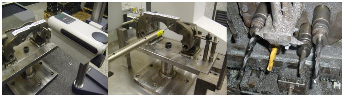
شکل ۲-۳۹، بستن مته‌های با پوشش M و D و اندازه‌گیری قطر و صافی سطح سوراخها
