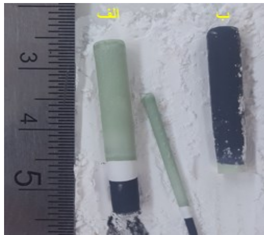
شکل ۳-۹ میکروپیل سوختی اکسید جامد لوله‌ای پس از تف‌جوشی؛ الف: پایه کاتد ب: پایه آند
