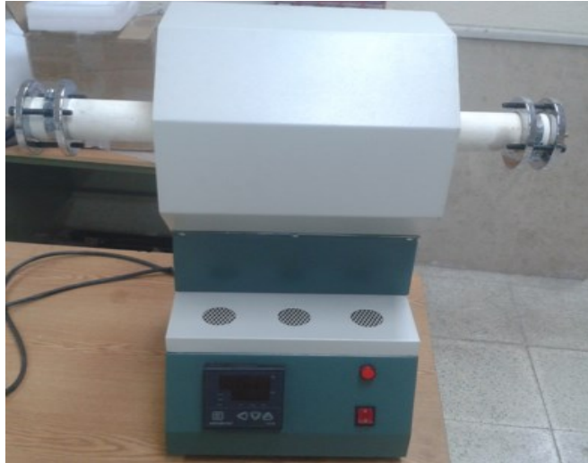
شکل ۱۱-۲ کوره لوله‌ای اتمسفر کنترل
