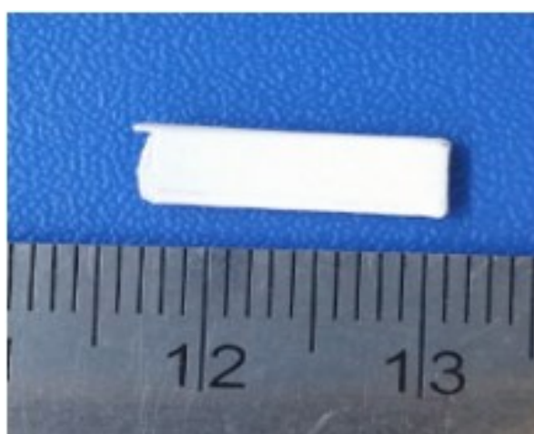
شکل ۱۲-۳ لایه الکترولیت صفحه‌ای پس از تفجوشی
