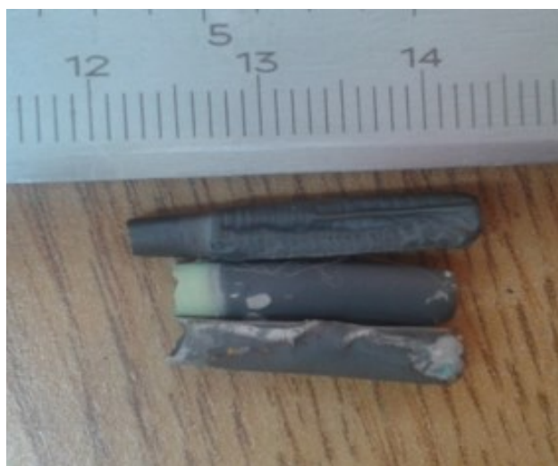
شکل ۱۱-۳ نمونه پخت شده در دمای تفجوشی نامناسب
