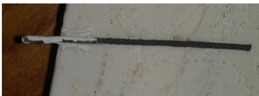
شکل ۳-۷ لایه راسب‌شده بر روی سیم مسی پس از پخت
