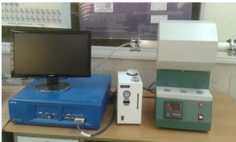
شکل ۲-۱۶ تصویر مجموعه تهیه شده برای اندازه گیری عملکرد الکتروشیمیایی پیل سوختی
