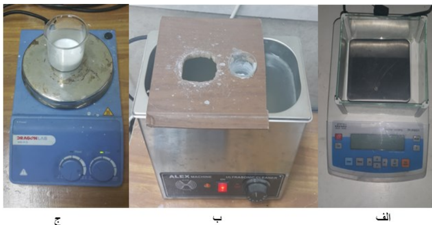
شکل ۲-۳- الف) ترازوی دیجیتال (ب) دستگاه اولتراسونیک (Alex Machine) (ج) همزن مغناطیسی (Dragon Lab)
