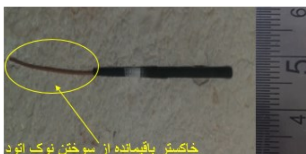
شکل ۳-۶ لایه راسب‌شده بر روی نوک اتود پس از پخت
