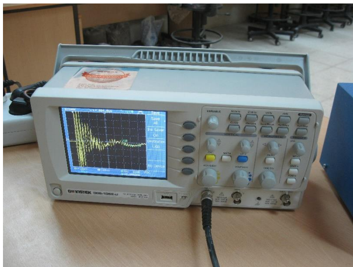
شکل ۳-۱۲: اوسیلوسکوپ مدل GDS-1052-U، استفاده‌شده جهت آشکارسازی سیگنال
