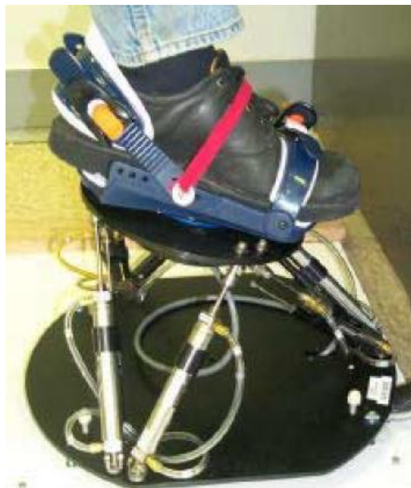
شکل ۱-۷. طرح دانشگاه rutgres برای توان بخشی عضلات مچ پا [۴]
