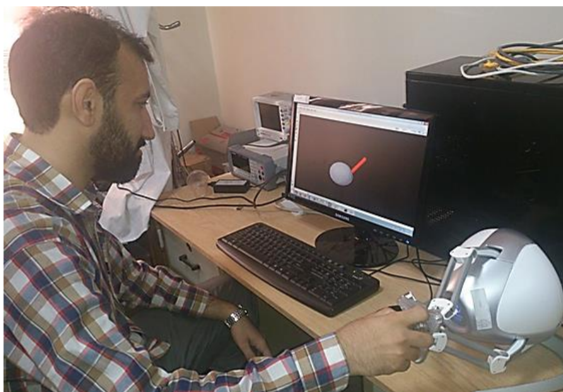
شکل ۵-۱۷: شبیه‌ساز کامل تعامل لامسه‌ای
