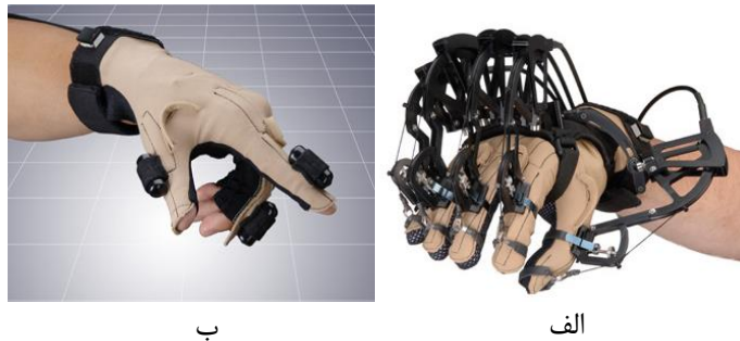
شکل ۲-۵: الف) دستکش غیرفعال سایبرگراسپ؛ ب) دستکش فعال سایبرتاچ [۳۹]
