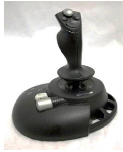
شکل ۸-۲: یک نمونه از اهرم‌های مایکروسافت دارای بازخورد نیرویی [۴۵]
