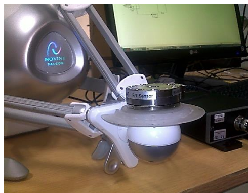
شکل ۳-۶: نصب حسگر نیرو روی گیره ربات فالکن
