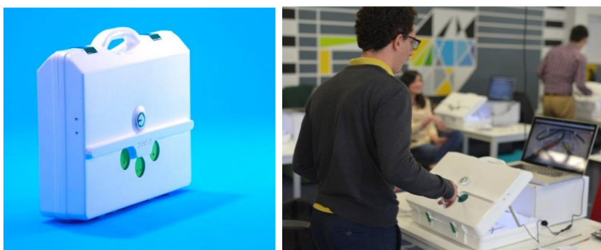
شکل ۲-۱۴: شبیه‌ساز شکم‌بینی قابل حمل ای‌اسیم [۵۲]
