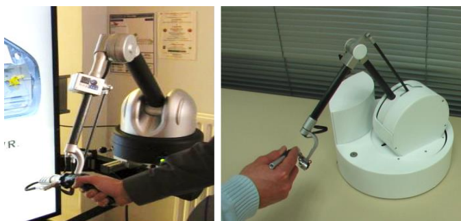
شکل ۱۰-۲: دو نمونه از افزاره‌های لمسی ویرچوس [۴۴]
