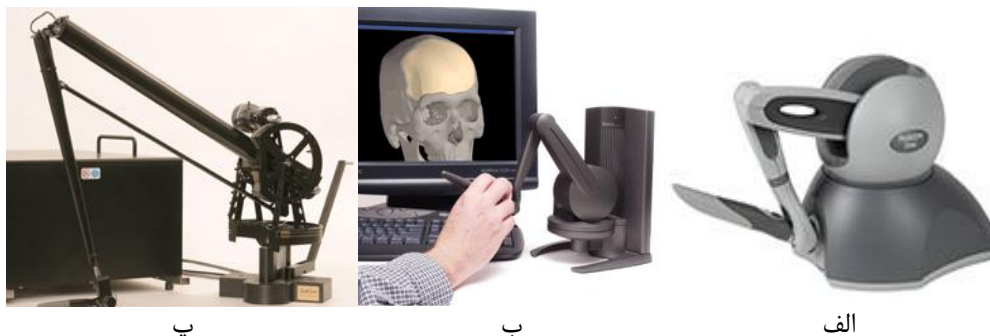
شکل ۹-۲: سه نمونه افزاره لامسه‌ای فانتوم: الف) فانتوم امنی؛ ب) فانتوم دسکتاپ؛ پ) فانتوم پرمیموم [۴۶]
