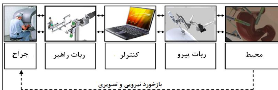
شکل ۲-۲: اجزای یک سامانه جراحی از راه دور [۱۵]
