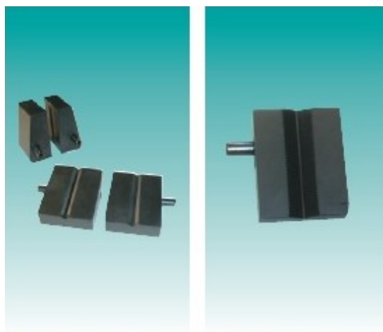
شکل (۳-۲) فیکسچر استاندارد دستگاه سروو هیدرولیک ۸۸۰۲
