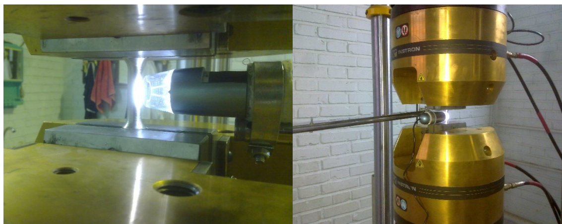
شکل (۱۲-۳) نحوه‌ی قرار گرفتن دوربین برای عکس برداری از نمونه‌ها
