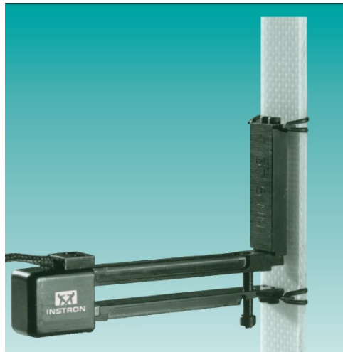
شکل (۲-۲) طول سنج استاندارد دستگاه سروو هیدرولیک ۸۸۰۲
