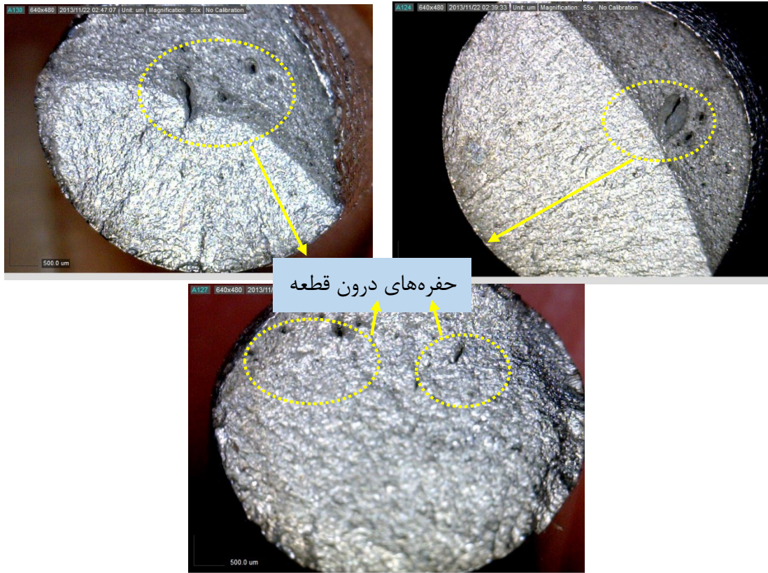
شکل (۳-۲۰) وجود حفره‌های کنترل کننده مسیر رشد ترک در نمونه‌های فولاد SS304
