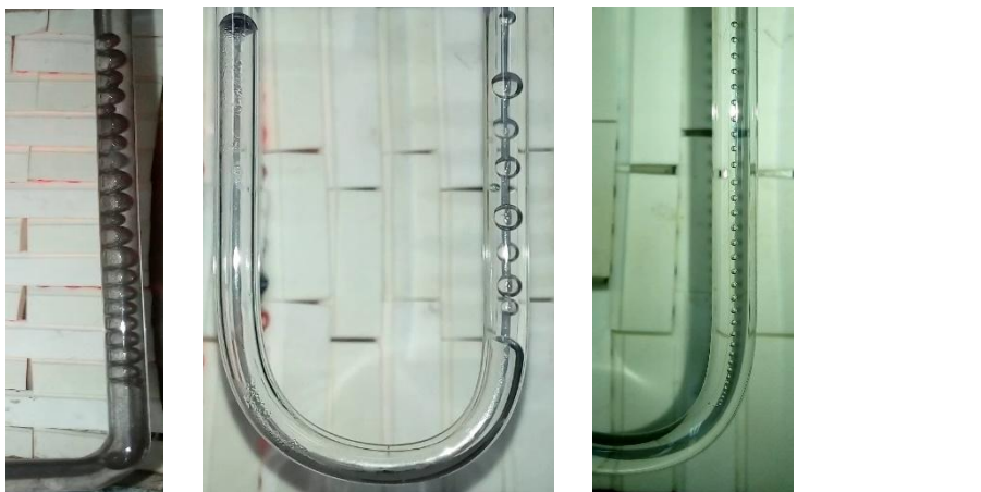
شکل ۴-۱: نمونه‌هایی از شکل حباب‌ها در محدوده‌ی رژیم جریان نوع اول
