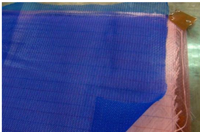
شکل (۹-۲): شبکه جریان رزین به‌عنوان آخرین لایه در فرایند تزریق رزین به کمک خلأ
