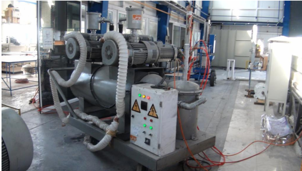
شکل (۲-۷): دستگاه پمپ خلأ پژوهشکده هواخورشید دانشگاه فردوسی مشهد
