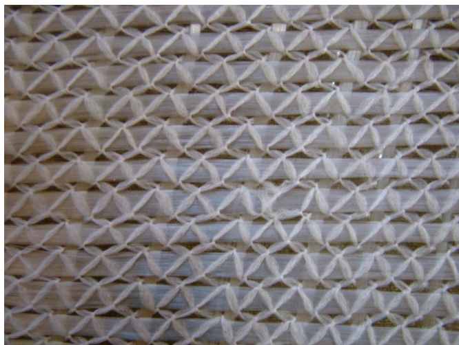
شکل (۱-۲): الیاف تقویت کننده کوک زده شده تک جهته شیشه نوع الکتريکی
