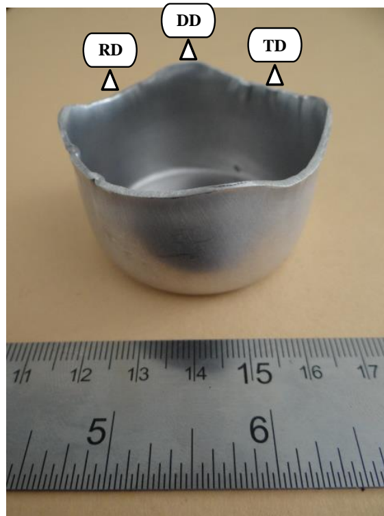
شکل ۴-۶- فنجان کشیده شده از آلیاژ AA3105
