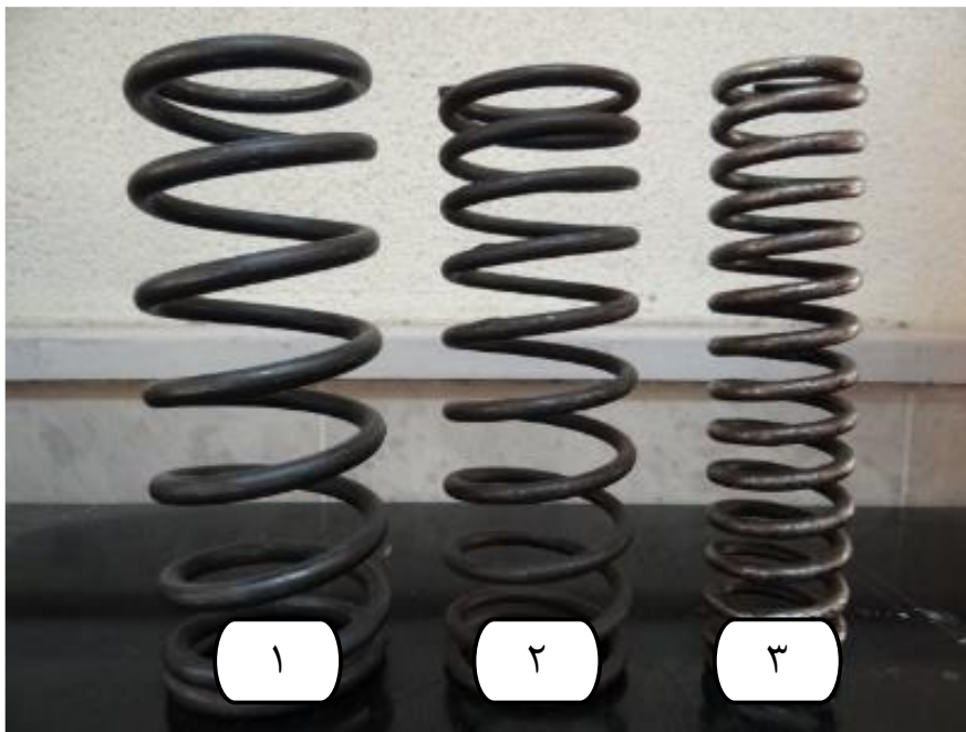
شکل ۳-۳- فنرهای قالب کشش
