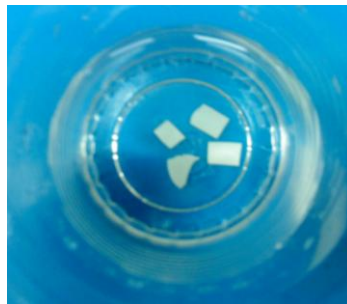
شکل ۲-۱۵- غوطه‌ور کردن نمونه‌ها در محلول نیترات ایتريم.
