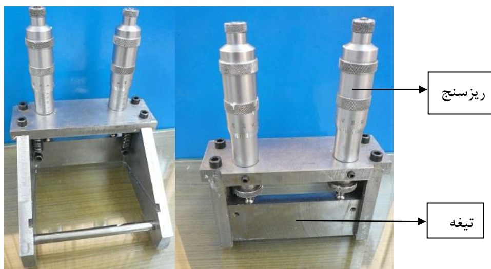
شکل ۲-۹- دستگاه دکتر بلید استفاده شده در این تحقیق.
