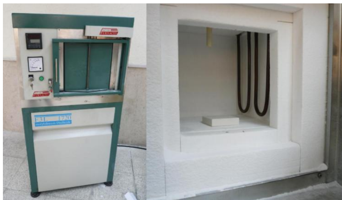
شکل ۲-۱۳- کوره تفجوشی (Azar Furnaces, Molybdenum Disilicide).
