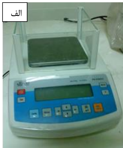
شکل ۲-۵ - الف) ترازوی توزین، ب) دستگاه آسیاکاری.
