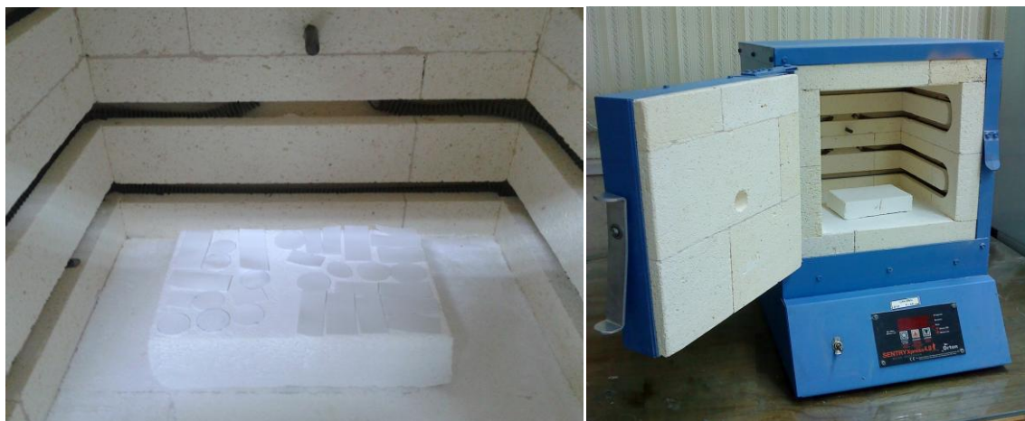
شکل ۲-۱۲- کوره خارج کردن مواد پلیمری (Paragon Industries, L.P.).
