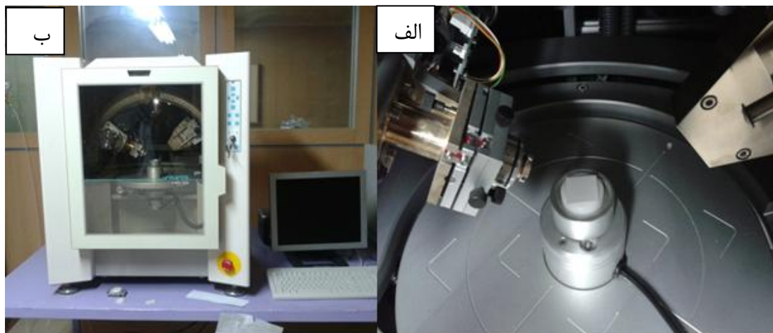
شکل ۲-۲۴-الف) نمونه‌ی تحت آزمون، ب) دستگاه پراش اشعه ایکس.
