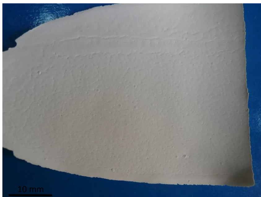
شکل ۳-۱۱- نوار خام دارای عیب پوست پرتقالی.
