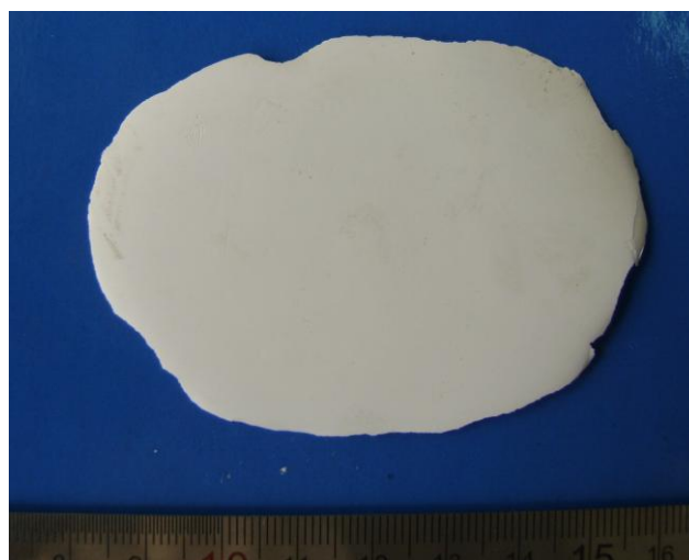
شکل ۳-۱۲- نوار خام بدون عیب.
