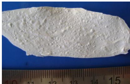
شکل ۳-۳- نوار خام تولید شده با چسب نامرغوب.
