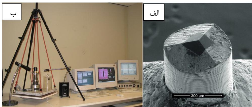
شکل ۲-۲۲- الف) فرورونده برکویچ [۴۲] ب) سیستم تریبواسکوپ.
