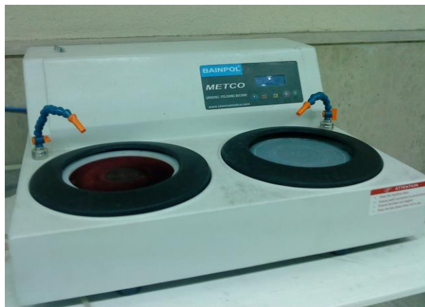
شکل ۲-۱۹- دستگاه پولیش (METCO).
