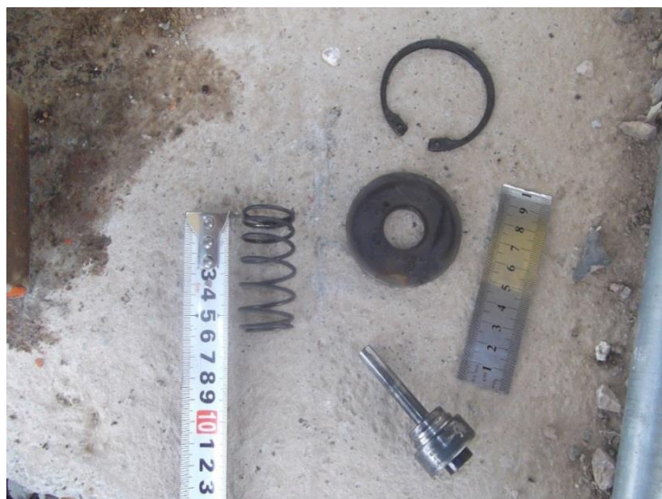
شکل ۱۱-۲: پیستون، خار نگه‌دارنده و فنربندی به‌طور تفکیک‌شده
