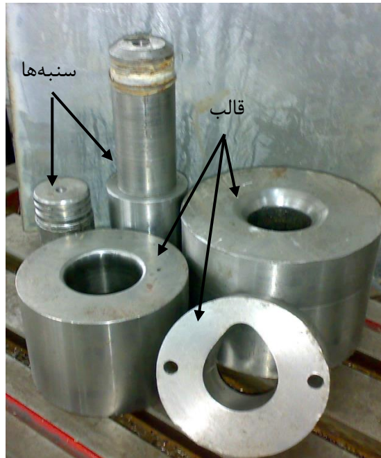
شکل (۳-۲) اجزای مختلف قالب هیدروفرمینگ لوله استفاده شده در این پژوهش
