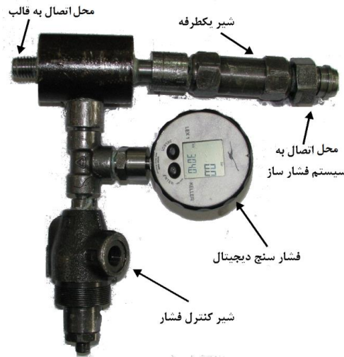
شکل (۶-۲) تجهیزات سیستم هیدرولیکی کنترل فشار
