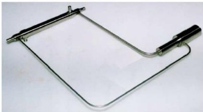
شکل ۲-۳- نمای کلی از یک LHP دارای شار حرارتی بالا در ناحیه تبخیر کننده [۳۸]
