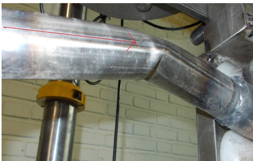
شکل (۲-۲۴). پوسته از نوع درزدار تحت بارگذاری خمش خالص
