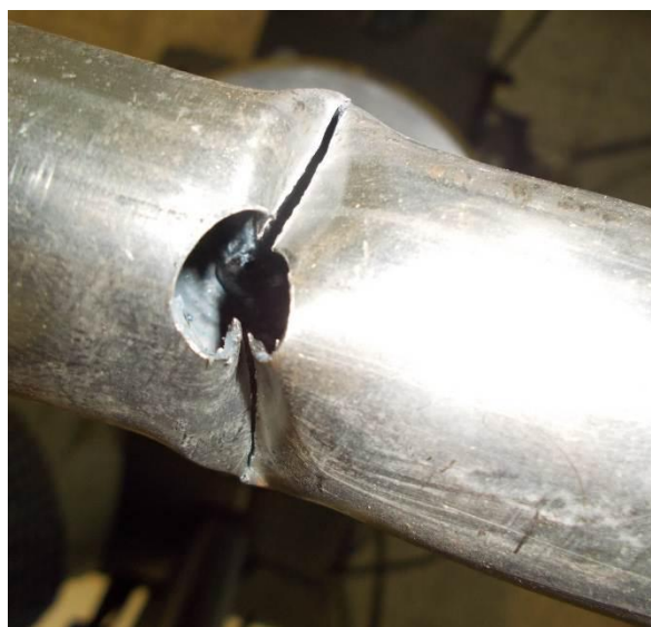
شکل (۲-۱۶). الف- جمع شدن گشودگی ب- شکست از محل گشودگی
