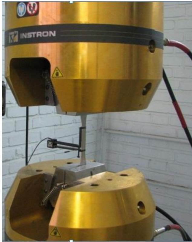
شکل (۲-۱). دستگاه سرو هیدرولیک اینسترون ۸۸۰۲ و استفاده از طول سنج برای تست کشش استاندارد
