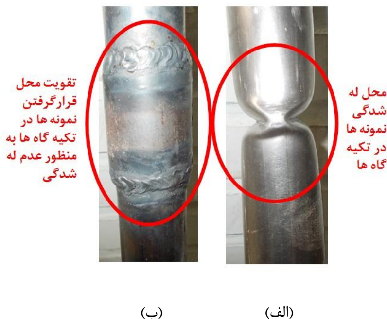
شکل (۲-۸). الف- له‌شدگی در محل فک‌های میانی ب- تقویت لوله در محل له‌شدگی
