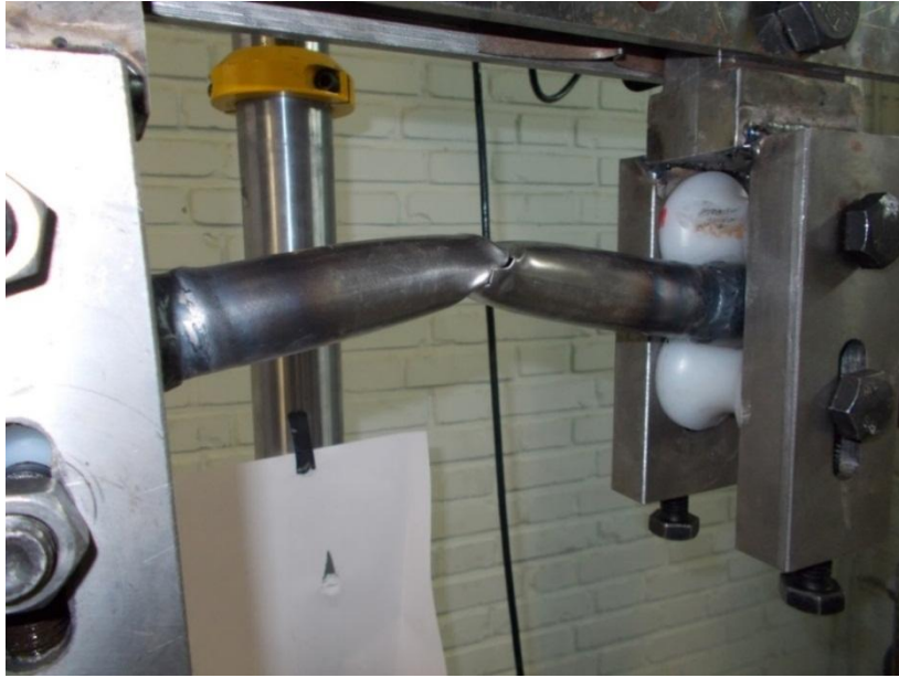
شکل (۲-۱۱). محل شکست در میانه پوسته استوانه‌ای بدون گشودگی با طول مؤثر 280mm و نیروی میانگین
