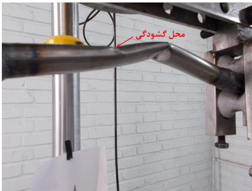
شکل (۲-۱۸). خمش در دونقطه ای میانی و محل گشودگی در پوسته ای استوانه ای
