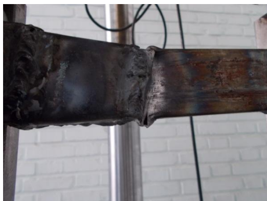
شکل (۲-۲۳). اضافه نمودن تقویت در محل تکیه‌گاه
