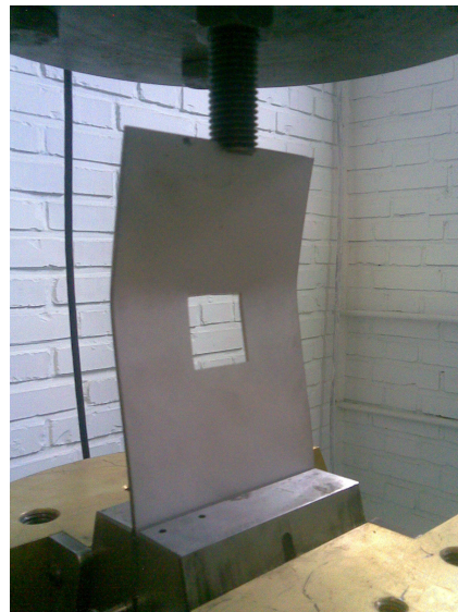
شکل (۱۱-۳) - شرایط بار گذاری و نحوه ی تغییر شکل نمونه با گشودگی مربعی (انتها تکیه گاه گیردار)
