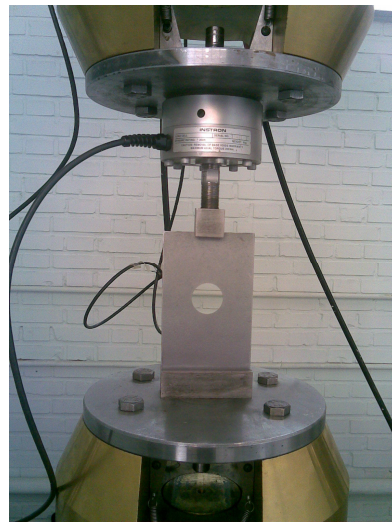
شکل (۱۰-۳) - شرایط بار گذاری و نحوه ی تغییر شکل نمونه با گشودگی دایروی (انتها تکیه گاه ساده)
