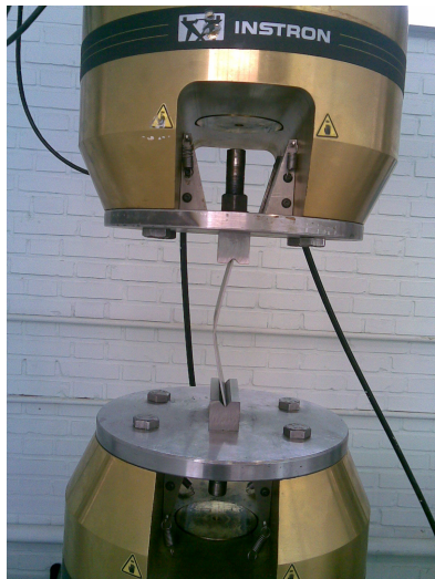
شکل (۱۰-۳) - شرایط بار گذاری و نحوه ی تغییر شکل نمونه با گشودگی دایروی (انتها تکیه گاه ساده)
