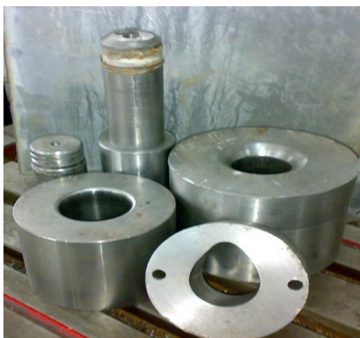
شکل ۳-۸: پرس هیدرولیکی و اجزای قالب هیدروفرمینگ
