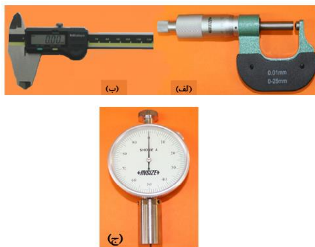
شکل ۳-۲۲: تجهیزات اندازه گیری: (الف) ضخامت سنج مکانیکی (ب) کولیس دیجیتالی (ج) سختی سنج لاستیک
