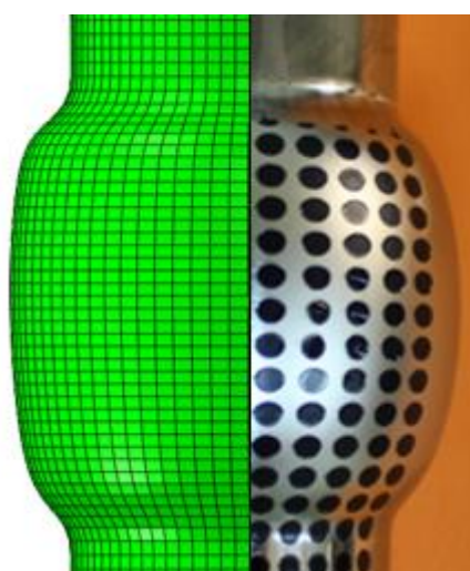
شکل ۴-۳۲: مقایسه هندسه تغییر شکل در شبیه‌سازی و آزمون تجربی
