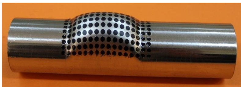
شکل ۴-۳۷: قطعه بادامک ساخته شده با روش RPF (روانکاری کامل - جابه‌جایی سنبه برابر ۲۳/۵ mm)
