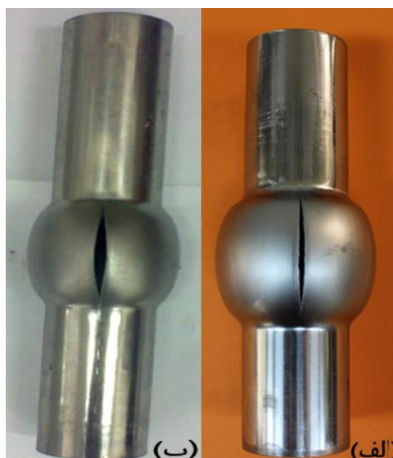
شکل ۴-۳۵: تصویر ترکیدگی لوله از ناحیه درز آن، (الف) فرایند RPF ، (ب) فرایند HF
