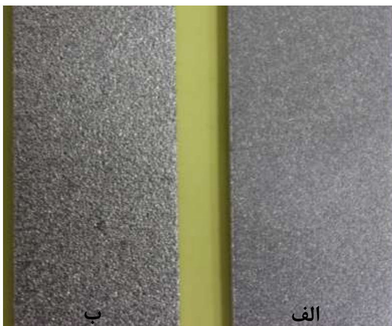
شکل ۴-۲۵- تأثیر ساچمه روی زبری سطح نمونه‌ها، الف) استفاده از قطر ساچمه d = 0.4 \text{ mm} ب) استفاده از قطر ساچمه d = 0.6 \text{ mm}
