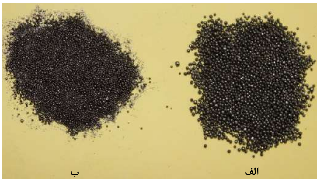
شکل ۲-۳- ساچمه‌های فولادی به کار رفته در آزمایش، الف) قطر d = 0.6 mm ب) قطر d = 0.4 mm
