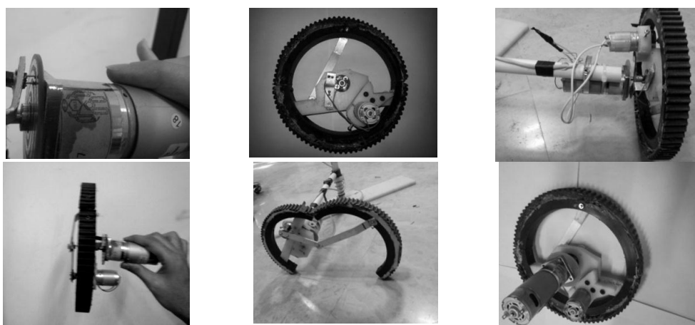
شکل ۲-۶ نمونه آزمایشی چرخ
