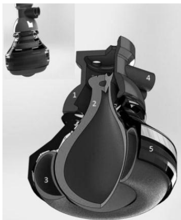
شکل ۸-۲ طرح سه بعدی گیره رباتیک ۱-اتصال بدنه به بازوی مکانیکی، ۲-بالن اصلی ۳-بالن حلقه‌ای، ۴-لوله‌های مکش هوا، ۵-بدنه نگاه‌دارنده بالن حلقه‌ای
