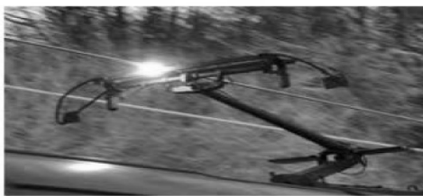
شکل (۳-۱) قوس الکتریکی در میان شبکه بالاسری و پانتوگراف
