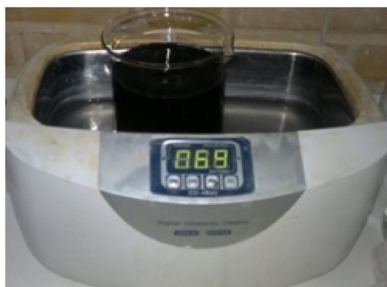
شکل ۶-۳: دستگاه ارتعاش مافوق صوت حمامی حاوی نمونه
