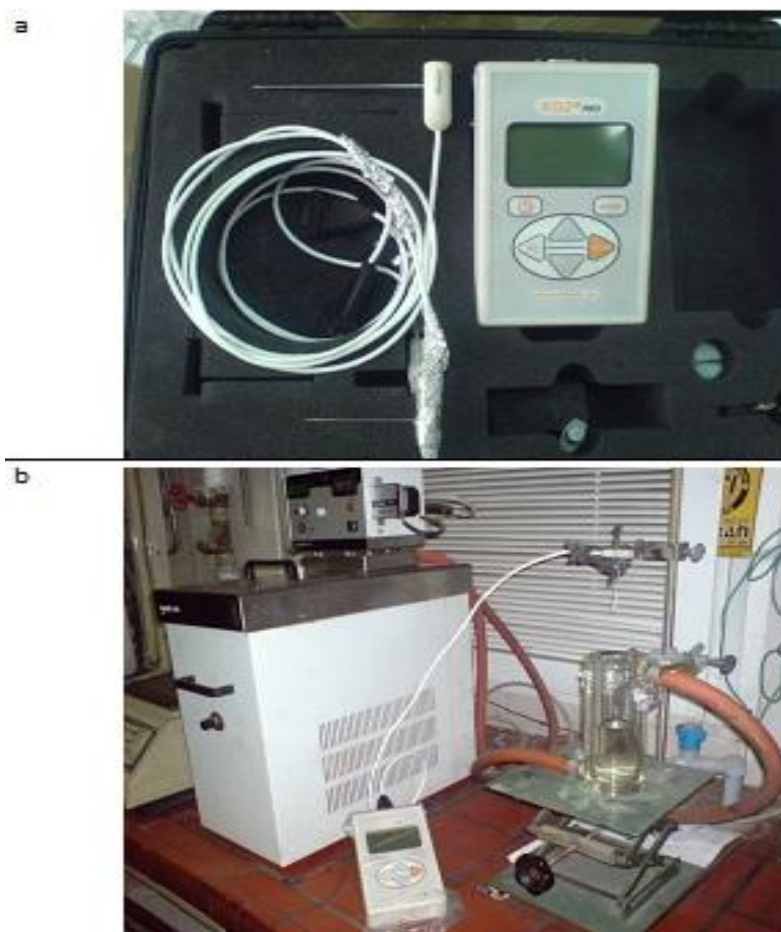
شکل ۶-۶: دستگاه KD2 جهت اندازه گیری هدایت گرمایی
