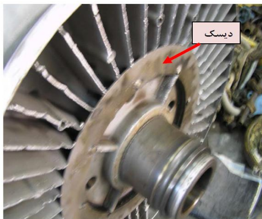
شکل (۷-۲) استفاده از دیسک بافل بر روی چرخ اولیه در کوپلینگ طرح قدیم
