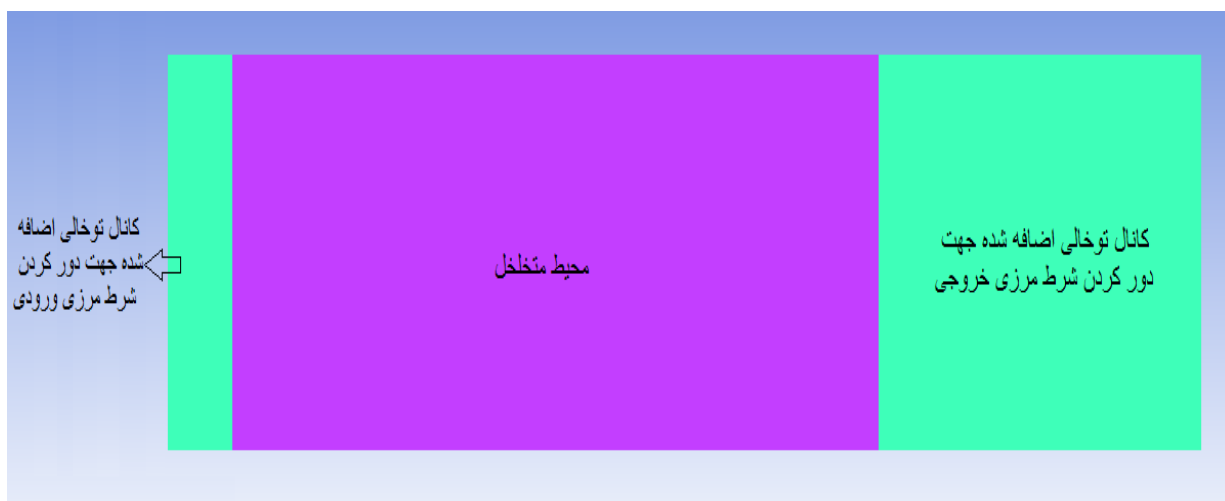
شکل ۳-۷ شکل شماتیک کانال بعد از افزایش طول
