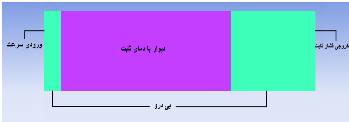
شکل ۳-۱۰ شماتیک اعمال شرایط مرزی برای قسمت‌های مختلف کانال
