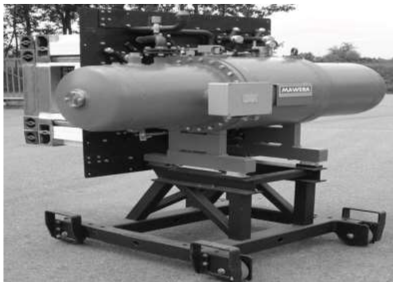
شکل (۱-۱۱): موتور استرلینگ ۳۵ کیلوواتی [۶]
