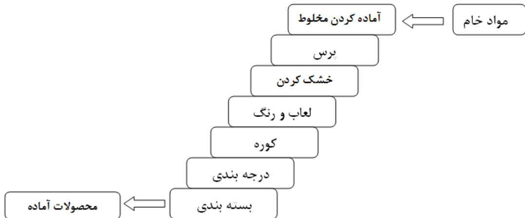
شکل ۱-۱ مراحل اصلی تولید کاشی‌های سرامیکی
